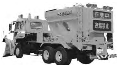
写真 6-24 凍結防止剤散布車 MS-BIT (F) W 型 範多機械(株) 平成 5 年
