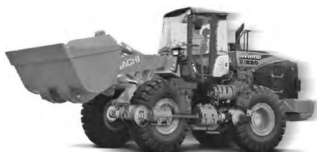
図5 ZW220HYB-5B のパワートレイン透視図 (イメージ図)
