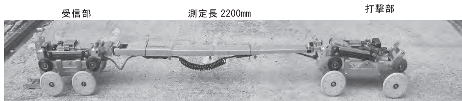
図三 φ 400 ～ φ 700 mm 測定用ロボット（HP 管長さ 2.43 m）
