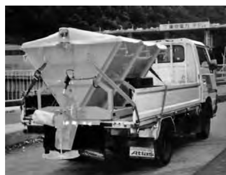
写真 6-23 搭載型散布機 1m 3 級 ESD10 東洋運搬機(株) (注1) 昭和63年
