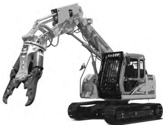
写真一 加藤製作所 HD513MR-6 油圧ショベル ショートリーチ解体仕様 (油圧圧砕機は古河ロックドリル(株)製 Vx225) (写真の仕様は一部オプションが含まれます)
