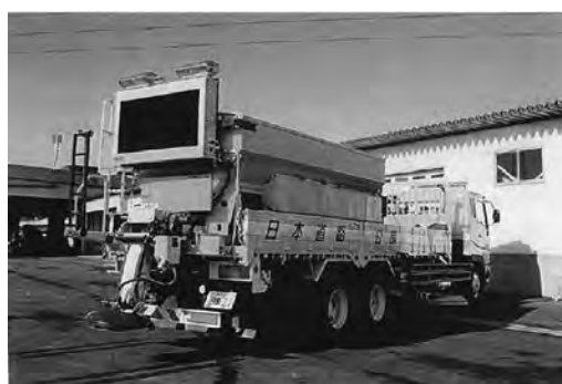
写真 6-38 湿式凍結防止剤散布車 SAB90FH ワイ・エンジニアリング(株) 平成 9 年
