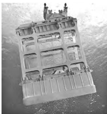
写真一九 法面浚渫ワイドグラブバケット
