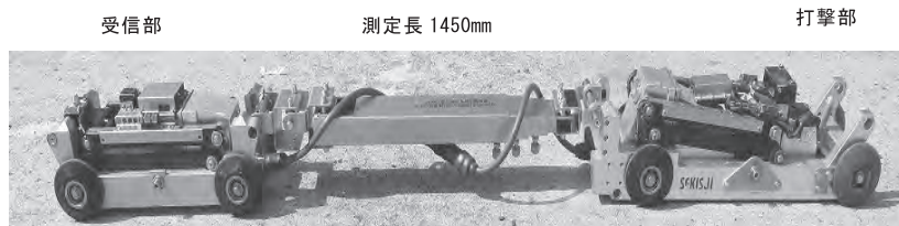
図二 φ 200 ～ φ 350 mm 測定用ロボット（HP 管長さ 2.00 m）
