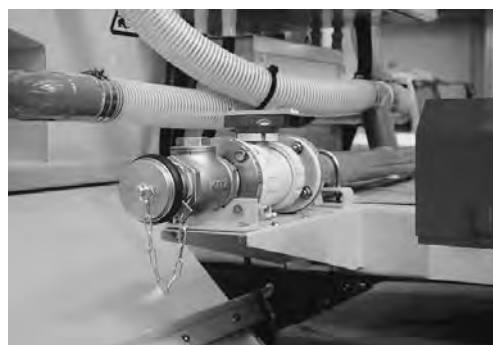
写真 6-27 湿式凍結防止剤散布車 MS-BWT の溶液外部供給接続装置 範多機械(株)
