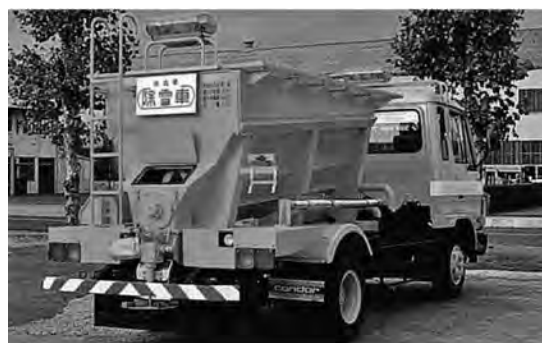
写真 6-22 乾式凍結防止剤散布車 2.5m 3 級 ESD25 東洋運搬機(株) (注1) 昭和63年
