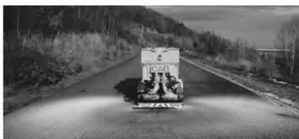
写真 6-57 大形の空港用湿式凍結防止剤散布車 NCS100TT2 (株)日本除雪機製作所 平成 17 年
