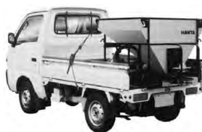
写真 6-54 車載式小型散布機 (サブエンジン油圧式) MS-03H 範多機械(株) 平成 14 年
