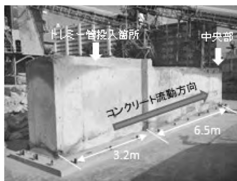
写真—6 高流動コンクリート試験
