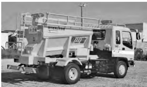
写真 6-45 乾式凍結防止剤散布車 JS25 東洋運搬機(株) (注1) 平成 10 年
