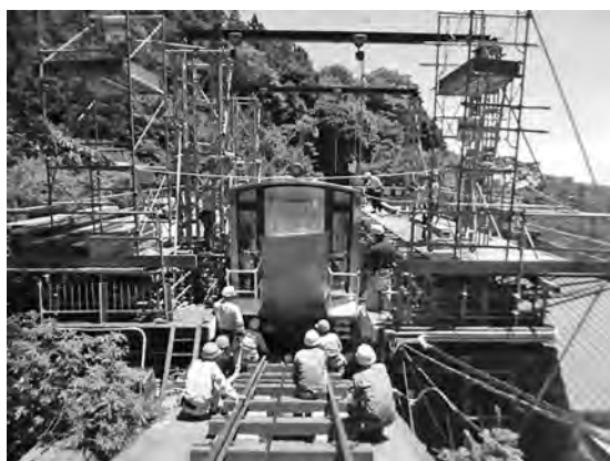
写真—14 新型車体と台車の結合状況
