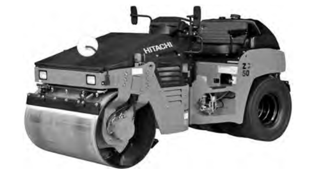
写真－3 日立建機 ZC50C-5 振動ローラ
