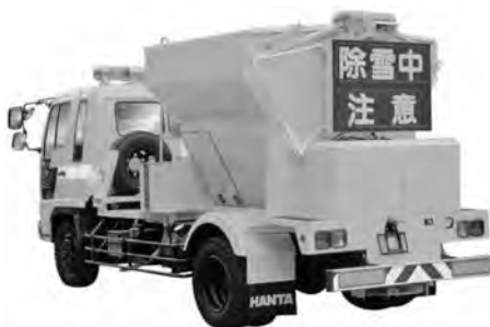
写真 6-44 湿潤式凍結防止剤散布車 MS-SWT 平成 10 年 国交省北陸地方建設局と範多機械(株)の共同開発
