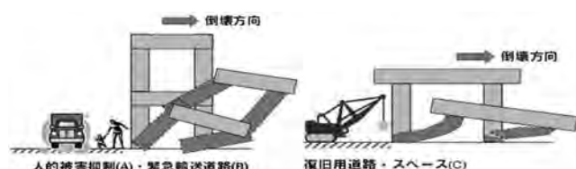
図—7 倒壊方向の制御 6)
