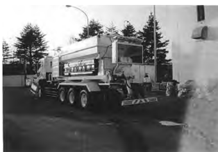
写真 6-53 湿式凍結防止剤散布車 ストラトス B120 ワイ・エンジニアリング(株) 平成 15 年
