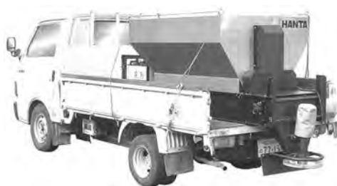
写真 6-39 車載式小型散布機（バッテリー式及びサブエンジン油圧式）MS-MG 範多機械(株) 平成 5 年
