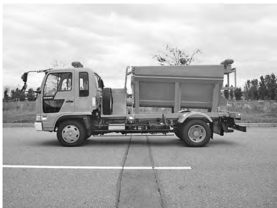
写真 6-48 乾式凍結防止剤散布車 NS25D 新潟トランス(株) 平成 13 年
