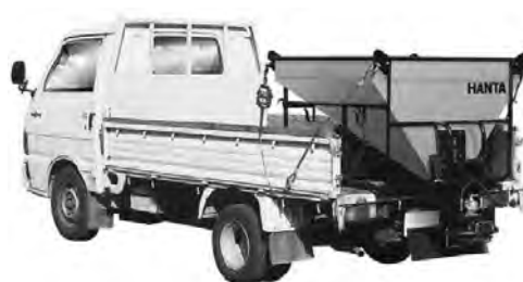
写真 6-55 車載式小型散布機 (バッテリー式) MS-AH 範多機械(株) 平成 15 年
