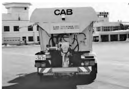
NCS25 形凍結防止剤散布車 (稚内空港)
