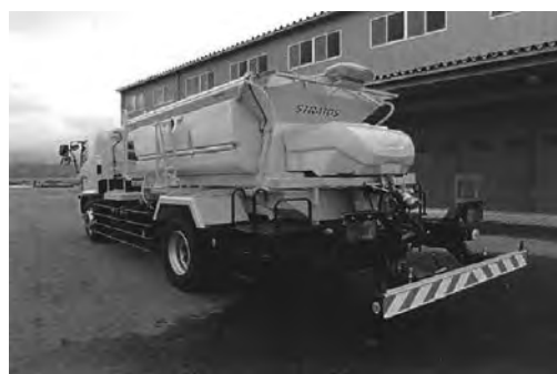
写真 6-59 空港用凍結防止剤散布車 ストラトス II B40 (秋田空港) ワイ・エンジニアリング(株) 平成 23 年
