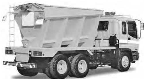
写真 6-46 乾式凍結防止剤散布車 JS80 TCM (株) (注2) 平成 11 年
