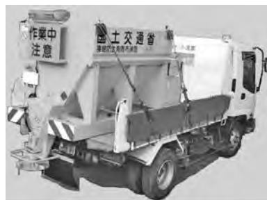
写真 6-49 車載搭載式散布機 NS20U 新潟トランス(株) 平成 16 年
