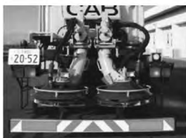
写真 6-57 大形の空港用湿式凍結防止剤散布車 NCS100TT2 (株)日本除雪機製作所 平成 17 年
