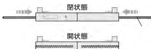
図—1 戸袋分離タイプの可動式ホーム柵
