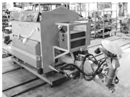
写真 6-51 湿式凍結防止剤散布車の国産化 (株)日本除雪機製作所 平成 19 年度
