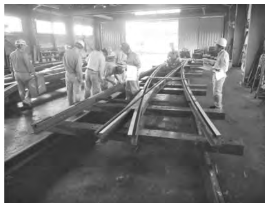
写真—4 仮組検査状況
