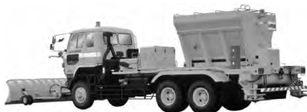
写真 6-42 空港用乾式凍結防止剤散布車 MS-40BIT（D）特 範多機械(株) 昭和 60 年
