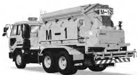
写真 6-56 空港用湿塩式散布車 MS-50BWT (特) 範多機械(株) 平成 11 年
