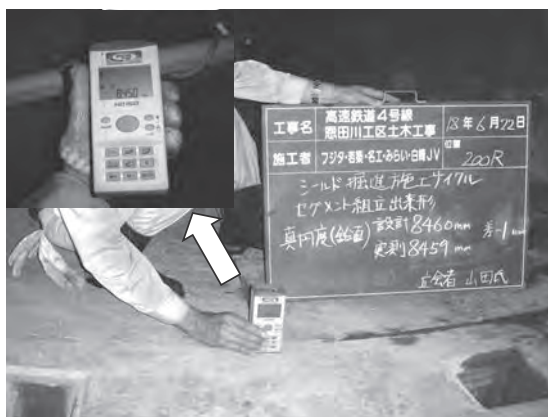
写真—1 従来のセグメント真円度計測方法
