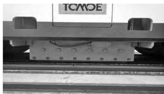
写真一 4 レールブレーキ
