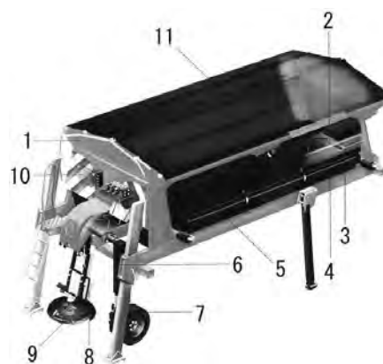
1. 溶接されたスチール製ホッパ 2. コンベアベルト 3. プラスチック製ローラー 4. ステンレススチール製固定カバー 5. 湿式散布用防錆ポリマータンク 6. 5th ホイール用テレスコピック式ガイド（インナー部分はステンレス） 7. ポリマー製マットガード 8. 調整可能型ステンレススチール製シュート 9. 散布ディスク 10. 内蔵型コントロールボックス 11. フォールディングカバー
