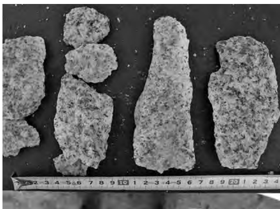
写真—6 掘削要素試験で発生したずりの岩片
