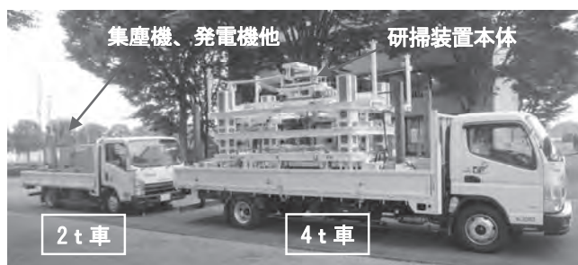
写真—3 天井用車載型乾式研掃装置
