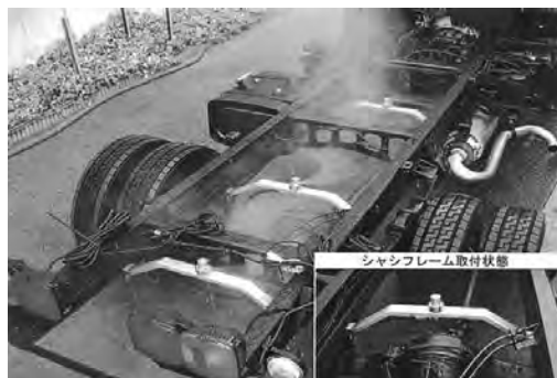
写真 6-78 シャシフレーム洗浄装置 (写真は 4～5.5t 車用) 範多機械(株) 平成 21 年
