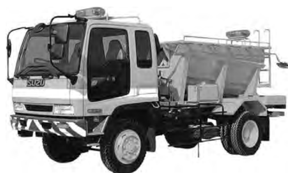
写真 6-74 高床式の車両 4 輪 2 軸駆動 (4 × 4)
