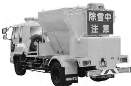
写真 6-75 低床式の車両 4 輪 2 軸駆動 (4 × 4)
