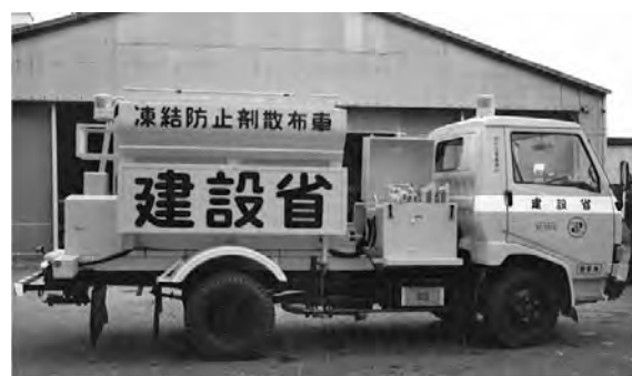
写真 6-73 標準タイプのトラック 4 輪 1 軸駆動 (4 × 2)
