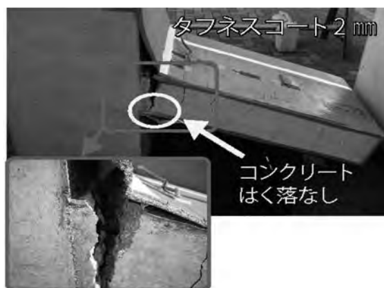
写真—3 RCT1-1 試験体の崩壊状況
