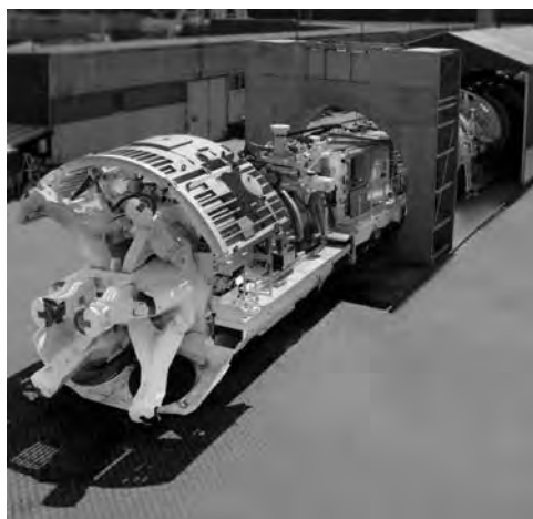
写真—3 海外メーカーが製作したディスクカッターによる掘削機 2)
