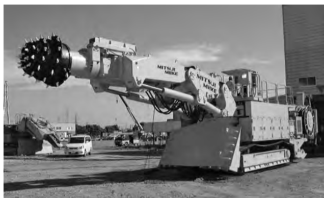
写真—2 国内最大級の自由断面トンネル掘削機 （ロードヘッダ SLB-350S） 1)
