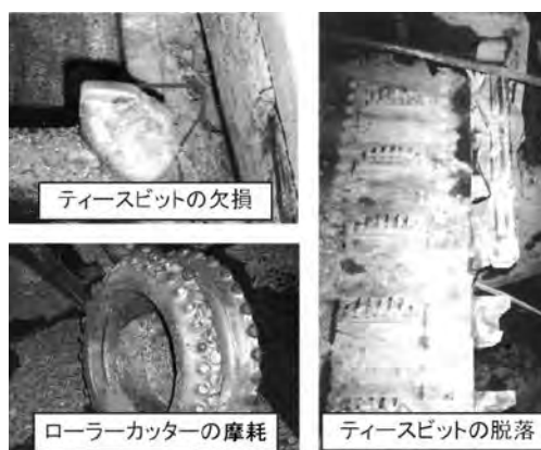
図ー3 不適合ビットによるトラブル事例
