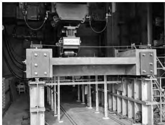
写真—1 輪荷重走行試験状況
