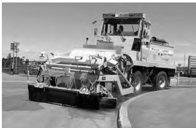
写真—4 路面清掃装置を装着したロータリ除雪車での路面清掃作業
