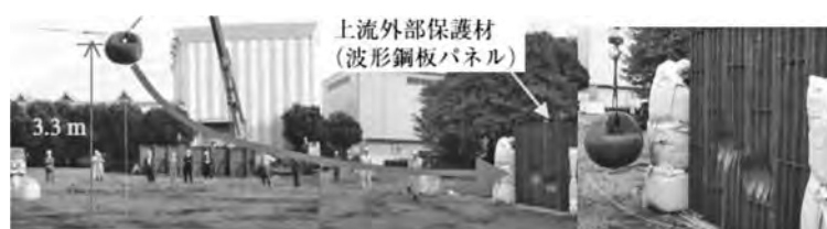
写真—3 波形鋼板パネルの実物大衝撃実験の状況
