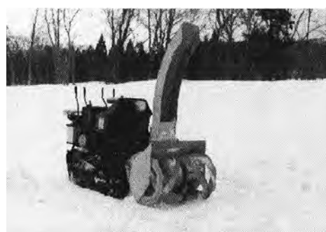
写真 7-16 小型除雪機 SC-6 東北地方建設局 昭和 56 年 3)
