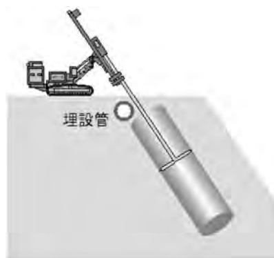
図—2 地中埋設物をかわした施工状況
