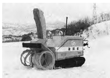
写真 7-15 小型除雪機 SC-4 東北地方建設局 昭和 54 年 3)
