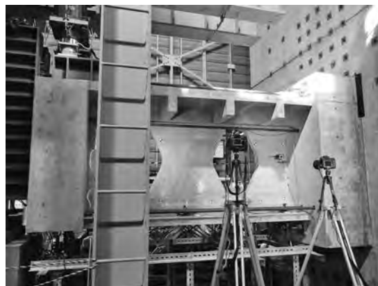
写真—2 せん断耐力実験状況
