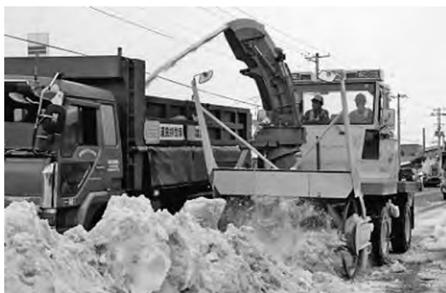
写真—5 ロータリ除雪車での運搬排雪作業
