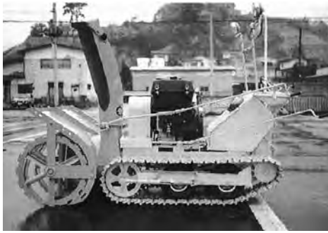
写真 7-17 小型除雪機 SD60U 白石工機(株) 20 PS 昭和 54 年 2)
