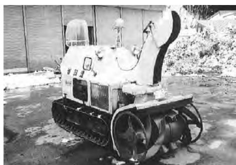
写真 7-11 小型除雪機 SC-3C 東北技術事務所 昭和 48 年 2)
