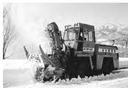
写真 7-48 小形除雪車（ロータリ装置装着） HTR140 (株)日本除雪機製作所 昭和 58 年
