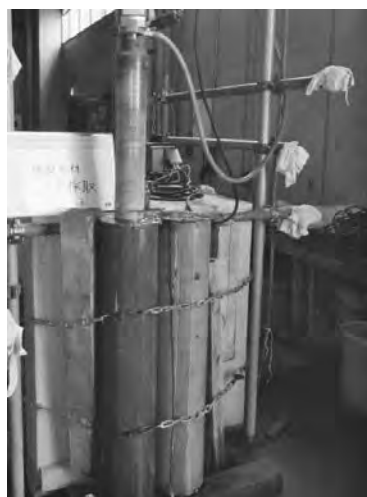
写真—2 コア採取状況（ \phi 200 \text{ mm} 模擬部材）
