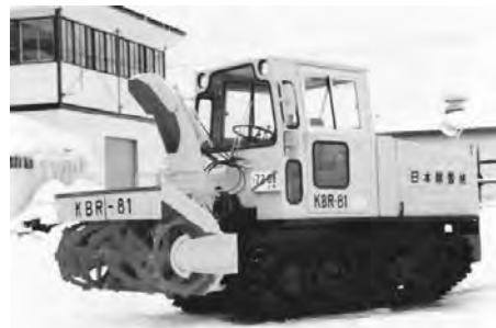
写真 7-46 小形除雪車（ロータリ装置装着） KBR81 (株)日本除雪機製作所 昭和 57 年
