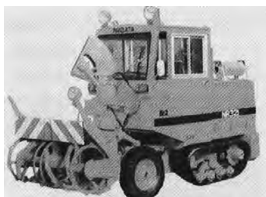
写真 7-37 小形除雪車 NR321 (株新潟鐵工所) (注3) 昭和 55 年 3)
