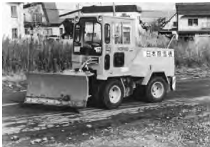
写真 7-43 小形除雪車（ブレード装置装着） HTR80 (株)日本除雪機製作所 昭和 56 年
