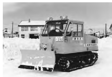
写真 7-35 小形除雪車 (ブレード装置装着) KBR80 北海道開発局, (株)日本除雪機製作所 昭和 51 年
