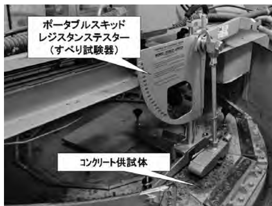
写真—1 すべり試験の状況
