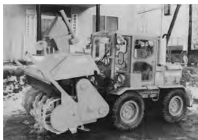
写真 7-36 小形除雪車 HK-60P 開発農機株式会社 (注9) 昭和 53 年
