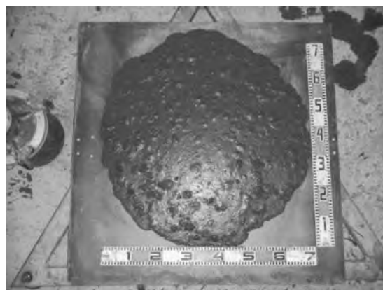
写真—6 コンクリートのフロー状況
