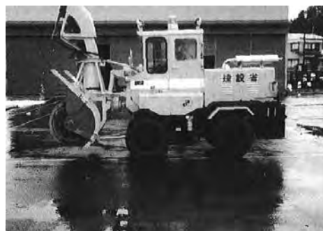
写真 7-27 小形除雪車 NR311 (株新潟鐵工所 (注3) ，北陸地建 昭和 43 年
