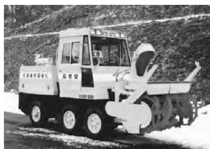
写真 7-53 小形除雪車 (ロータリ装置装着) KBR100 (株)日本除雪機製作所 昭和 61 年
