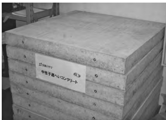
図一 2 開発した中性子遮蔽コンクリート
