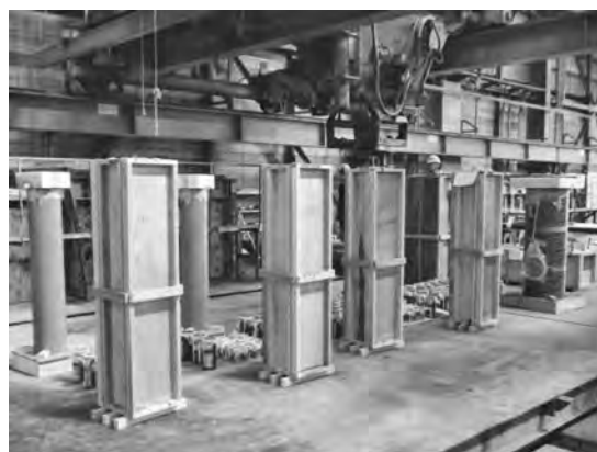
写真—1 実機実験における模擬部材の例
