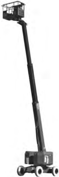
写真―2 アイチコーポレーション SP12CSN 自走式高所作業車
