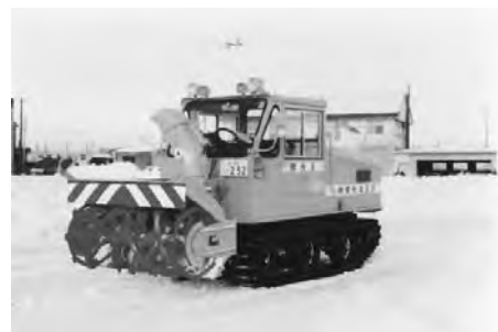
写真 7-34 小形除雪車 (ロータリ装置装着) KBR80 北海道開発局, (株)日本除雪機製作所 昭和 51 年
