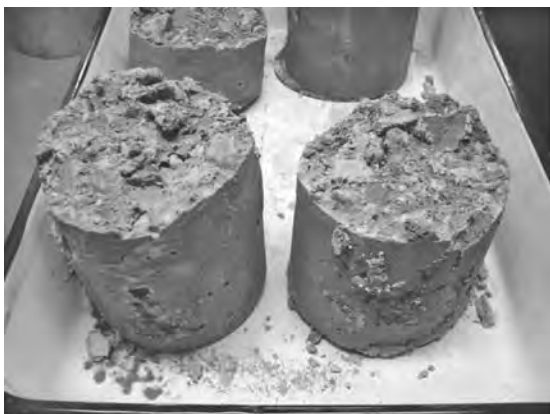
図一 1950年代当時の製法で再現したコンクリート
