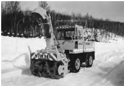
写真 7-57 小形除雪車 (ロータリ装置装着) HTR141 (株)日本除雪機製作所 昭和 63 年
