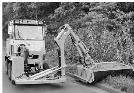
写真 7-87 小形除雪車 KBR101 のアタッチメント・全油圧式ディスク形草刈り装置 (株)日本除雪機製作所 平成 15 年
