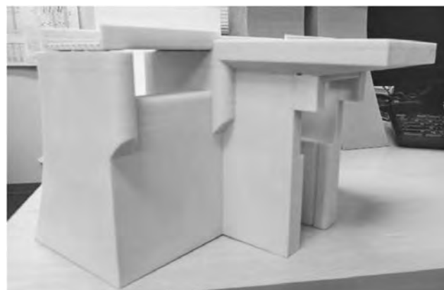
写真ー2 取水塔近傍の 3D モデル
