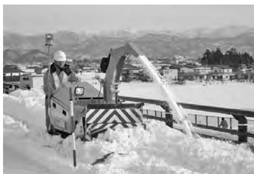
写真 7-89 ハンドガイド式小形除雪機 国土交通省東北技術事務所開発 平成 19 年
