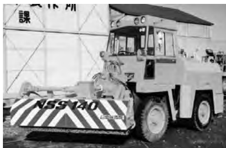
写真 7-82 小形除雪車 HTR140 のアタッチメント・路面清掃装置 (株)日本除雪機製作所 昭和 59 年
