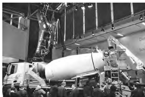
写真—19 ミキサー・ポンプ搭載車
