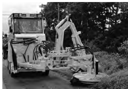
写真 7-88 小形除雪車 KBR101 のアタッチメント・全油圧式ワンパス形草刈り装置 (株)日本除雪機製作所 平成 18 年
