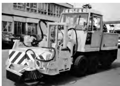
写真 7-85 小形除雪車 KBR100 のアタッチメント・路肩清掃装置 (株)日本除雪機製作所 平成元年
