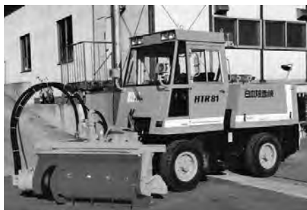
写真 7-84 小形除雪車 HTR81 のアタッチメント・路肩汚泥処理装置 (株)日本除雪機製作所 昭和 63 年
