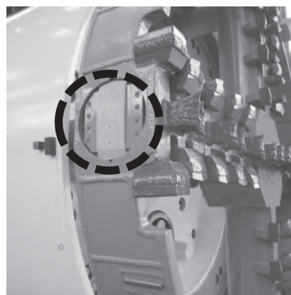
写真一1 センサー設置状況
