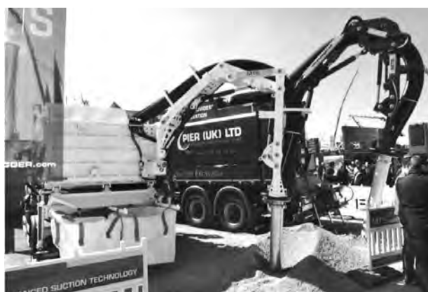
写真—12 吸引方式の掘削機械
