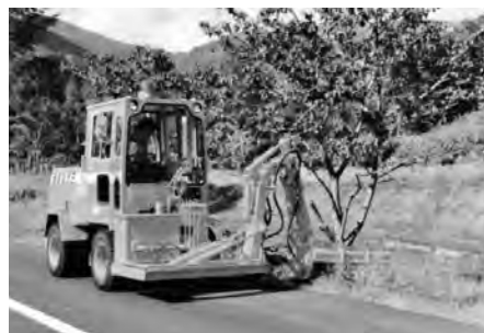
写真 7-81 小形除雪車 HTR80 のアタッチメント・全油圧式バロネス形草刈り装置 (株)日本除雪機製作所 昭和 56 年
