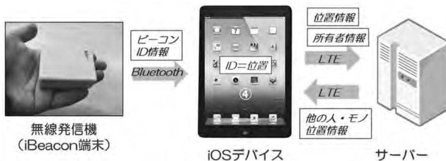
図一 2 位置を認識する仕組み
