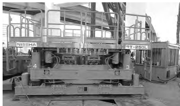
写真—7 日本車両 RT-250L 全回転チュービング装置
