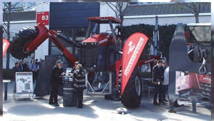
FOCKERSPERGER (ドイツ) 配管・ケーブル等埋設機
