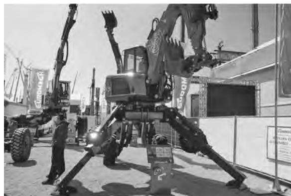
写真—9 4輪4脚式の油圧ショベル
