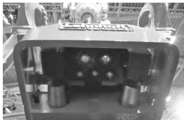
写真—15 付替容易なクイックカブラ
