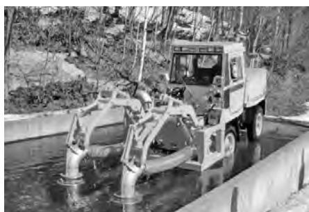
写真 7-86 小形除雪車 KTR141 のアタッチメント・排水ポンプ装置 (株)日本除雪機製作所 平成 14 年
