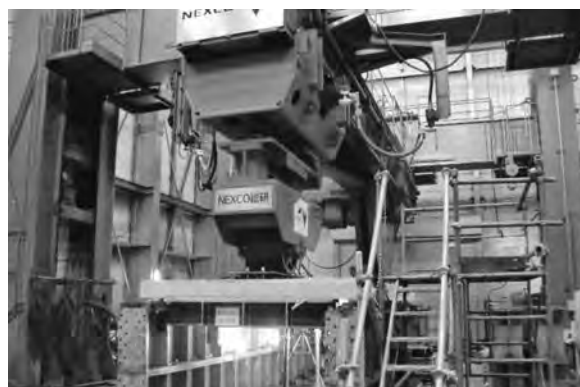
写真—8 輪荷重走行試験状況
