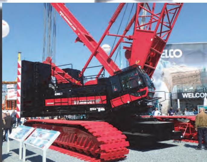
KOBELCO (日本) 250 t クレーン
