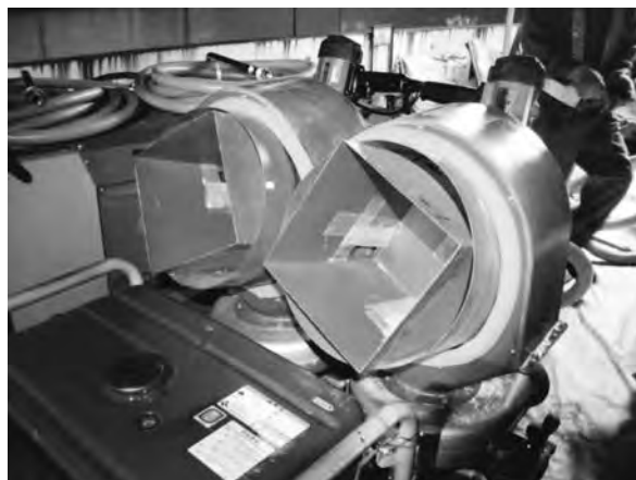
写真—13 繊維圧送機
