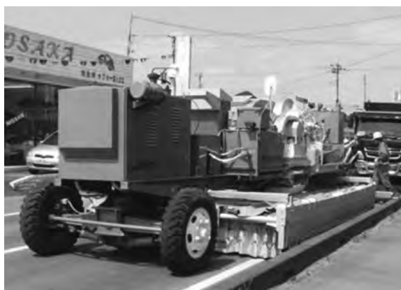
写真—3 路面ヒータ
