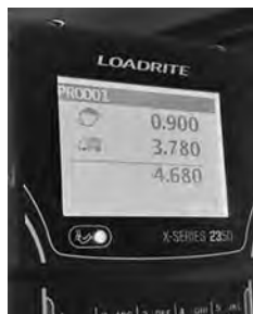
写真-3 900 kg の錘を使用した確認
