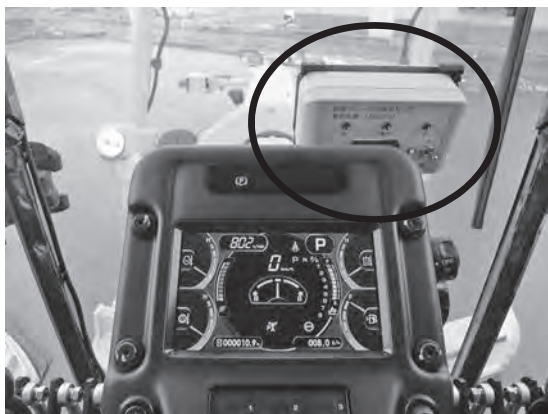
写真—5 オペレータへの通知機器
