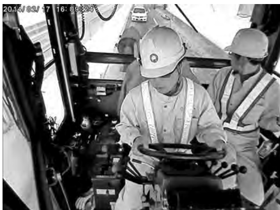
写真—1 梯団の間に位置する一般車 オペレータ：分離帯や装置状況を確認 助手：近接車両を確認
