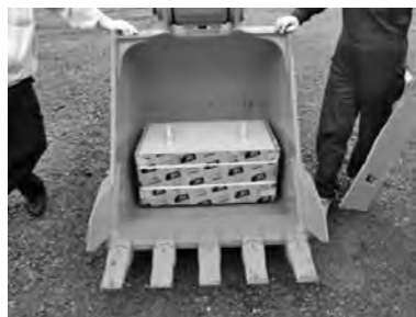
写真-3 900 kg の錘を使用した確認
