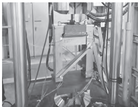
写真一八 吊支持材静的試験
