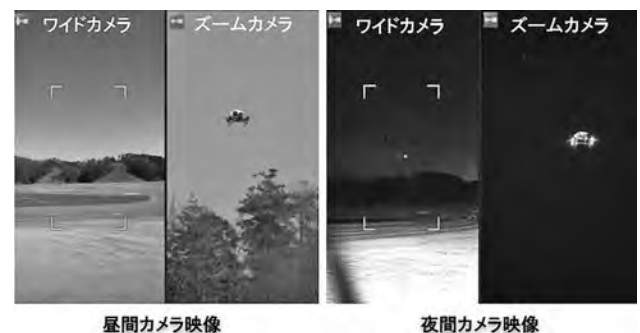
図—7 100m先のドローン監視映像
