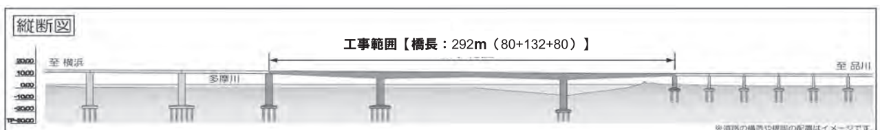
図-8 高速大師橋構造概要図
