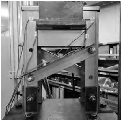
写真-9 吊支持材疲労試験
