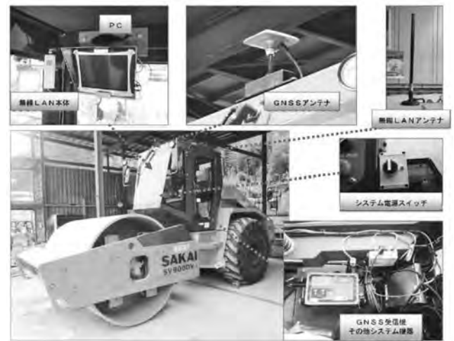
図一 11 転圧ローラー設備設置状況
