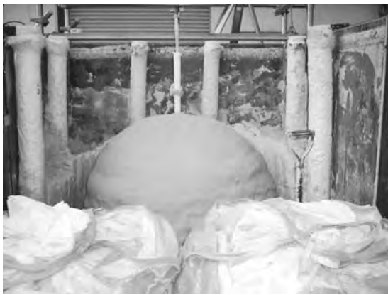
写真一 確認された改良体 (模型注入実験)
