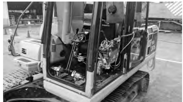
写真一 3 汎用遠隔操縦装置「サロゲート」概観
