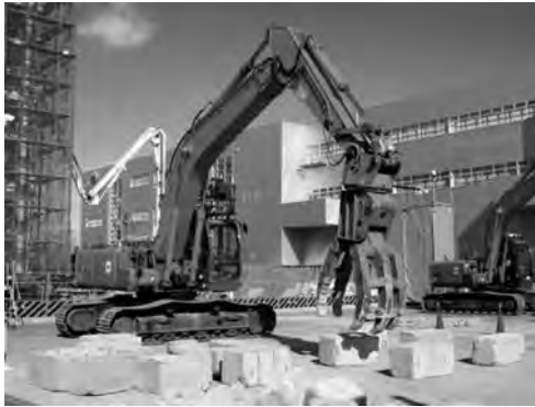
写真一 2 3D画像と体感型操縦を用いた「次世代無人化施工システム」
