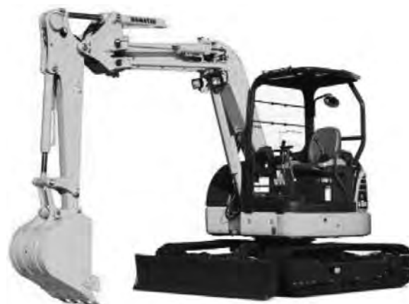
写真一 コマツ PC58UU-6 超小旋回ミニショベル (一部オプションが含まれる)
