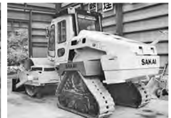
写真一6 クローラ駆動振動ローラ
