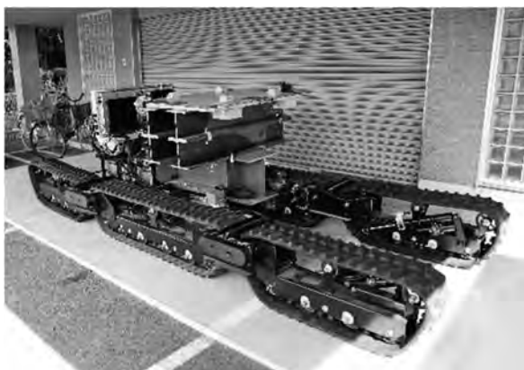
写真一八 開発したロボットの走行装置
