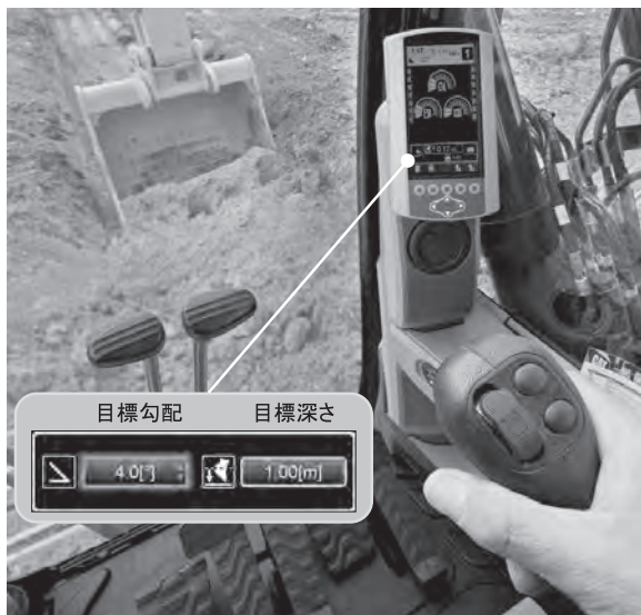
図一 本改良システム情報を表示する標準モニタ及びスイッチ付ジョイスティック
