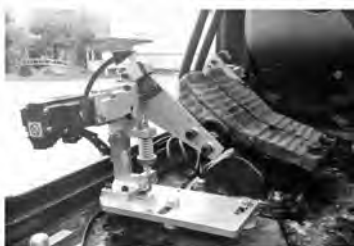
サーボモーター+円弧状ギヤで操作
