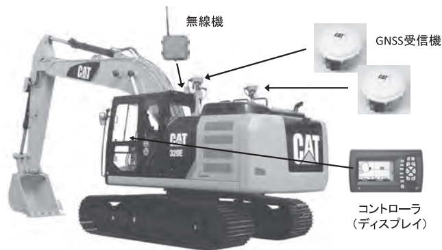
図一 4 本3次元用コンポーネント機器装着イメージ(※図はGNSS仕様)
