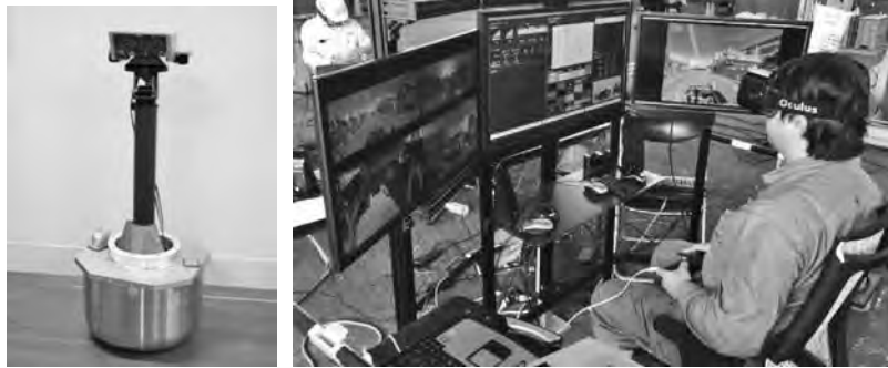
写真—10 屋外用 TORSO の外観と HMD を装着した遠隔操縦の状況
