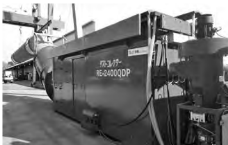
写真一5 流機エンジニアリング RE-2400QDP トンネル工専用大型集塵機(工場内)
