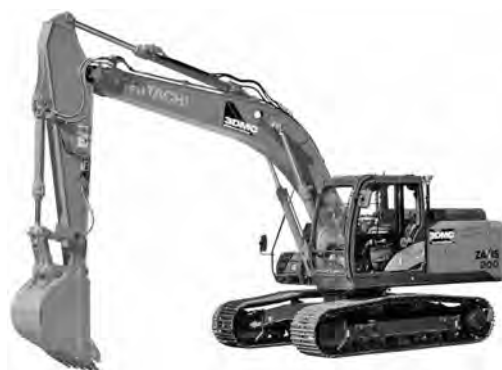
写真一八 日立建機 ZX200X-5B ICT 油圧ショベル
