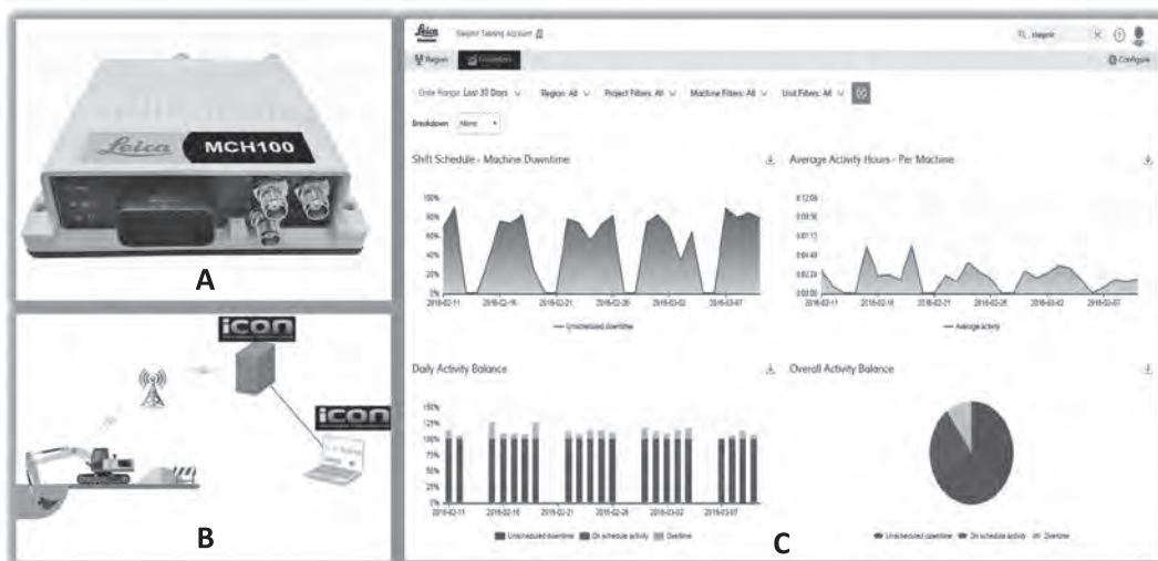
図一5 A) 単独 GNSS システム B) クラウド利用による通信システムのイメージ図 C) 各重機の稼働状況集計データ
