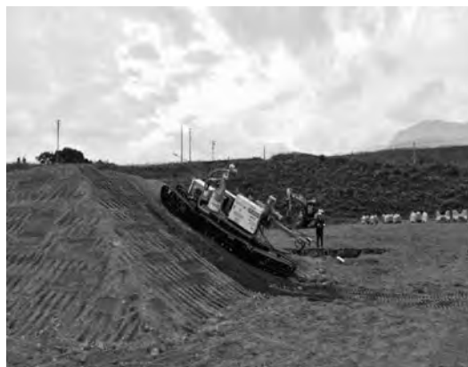
写真—13 勾配走行（登坂）試験（写真右はスリップ痕）
