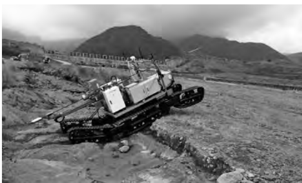
写真—12 段差乗り越え試験
