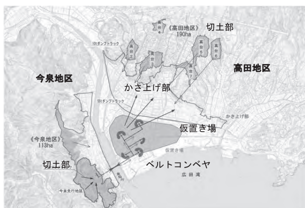
図一 切土部（赤）とかさ上げ部（黄）までの土運搬の流れ
