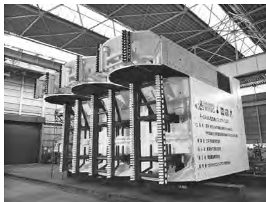
写真—4 鹿島建設 R-SWING 機 揺動型掘削機
