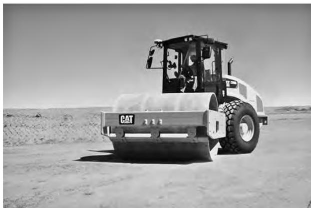
写真-1 キャタピラージャパン CS56B 土工用振動ローラ
