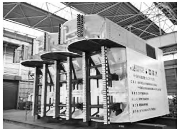
写真-1 3連揺動型掘進機全景
