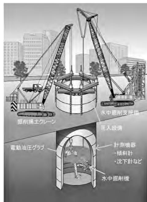
図1 自動化オープンケーソン工法概要図
