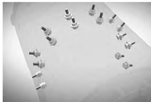
図一四 中胴部, 後胴部縮径・復元ジャッキ配置
