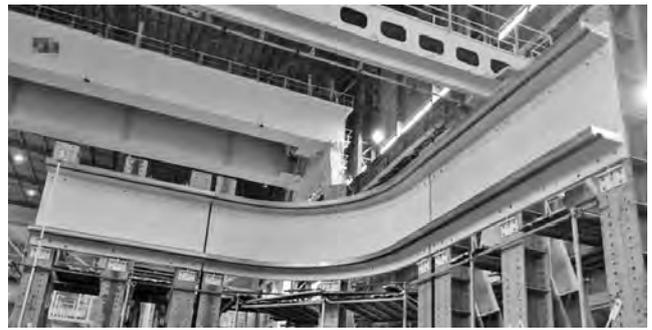
写真—3 直線部と曲線部を組み合わせた走行レール
