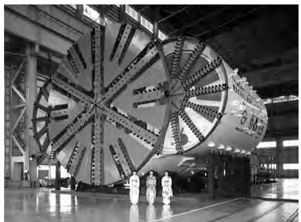
写真—14 南北線白金台駅で採用した着脱式泥水三連型シールド
