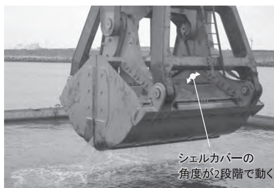
図-11 容量可変グラブバケット実機
