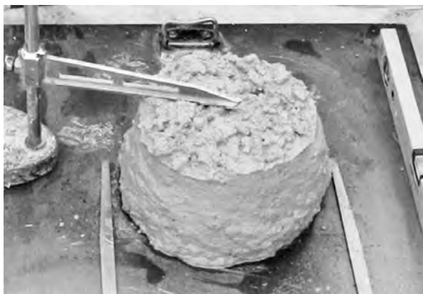
写真-4 スランプ試験状況
