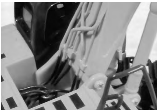
写真—2 付け替えた配管の状況
