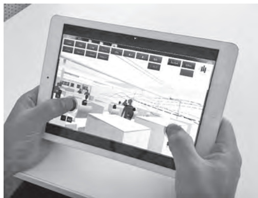
図一3 タブレットでのシミュレーションのVR表示例 (BIMと室内気流シミュレーションの同時表示)
