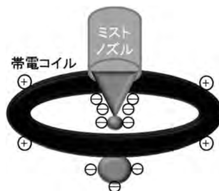
図一 帯電ミスト発生原理
