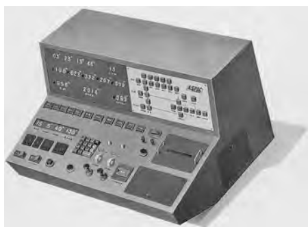
写真 3-57 アスパックマイコン制御操作盤
