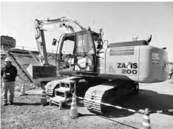
写真一 3 バックホウマシンコントロール
