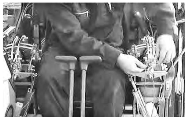
写真一3 操作レバーガイドステーに装着したピンの着脱
