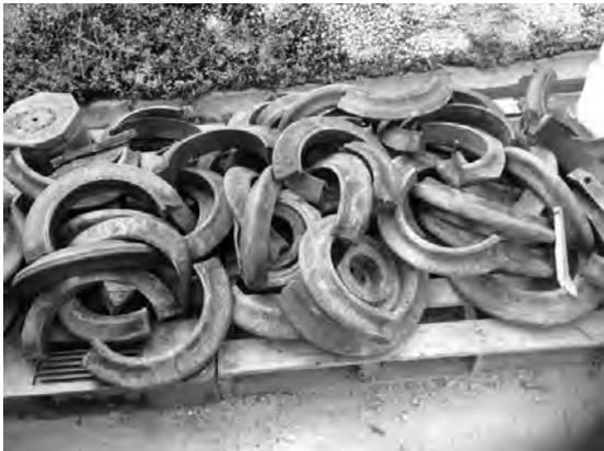
写真-2 カッターリング破損状況
