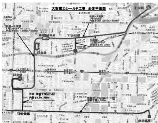
図-2 立坑配置・シールドトンネルルート
