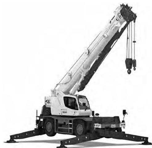
写真-8 タダノ GR-250N ラフテレーンクレーン (作業姿勢)
