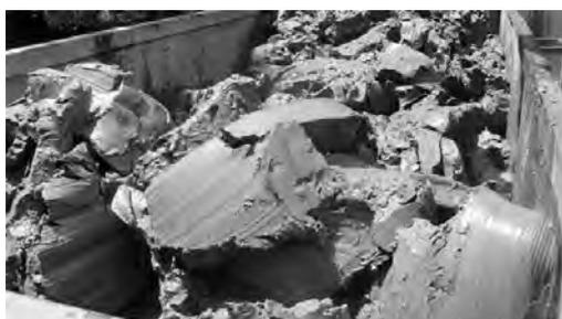
写真一十 掘削された硬質粘土
