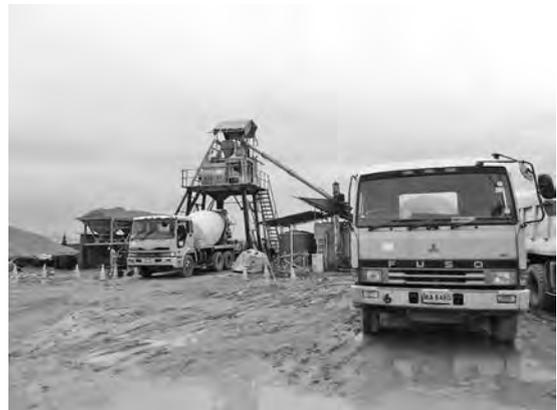
写真一11 コンクリートバッチングプラント
