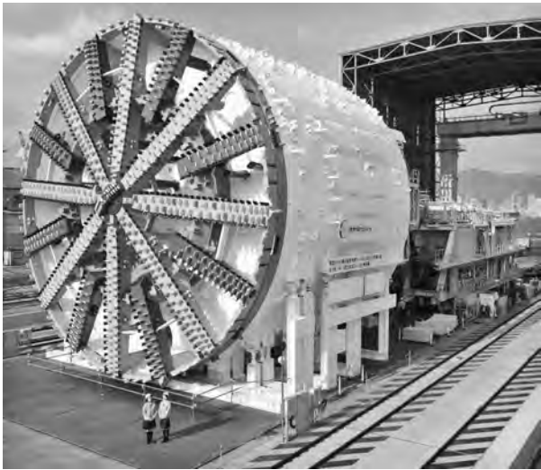
図—9 JIMテクノロジー 泥土圧シールド掘進機（φ 16.1 m）の神戸工場完成写真
