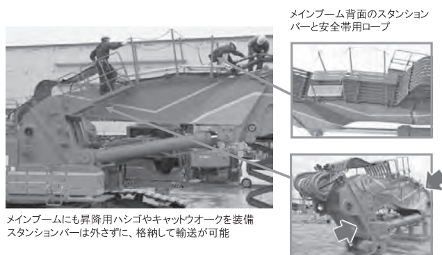
写真—3 メインブームの作業足場とアクセス
