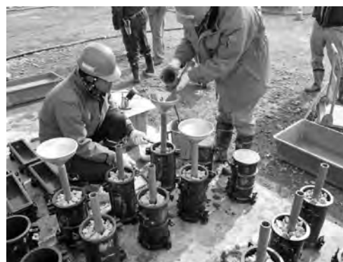
写真—6 φ 150 mm プレバッキング工法供試体の作製状況
