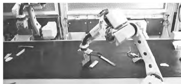
写真ー8 選別ロボットによる廃棄物選別状況
