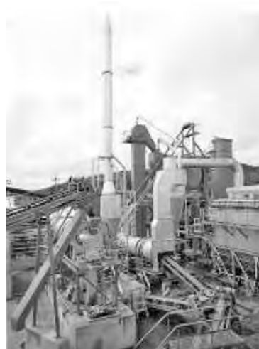
写真 4-18 併設型リサイクルプラント 左ドライヤが 30 t/h リサイクル用ドライヤ 右ドライヤが 60 t/h バッチプラント用ドライヤ
