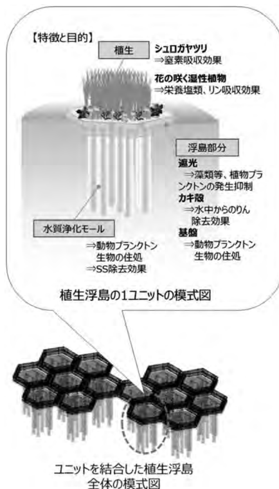
図—9 植生浮島の特徴と模式図
