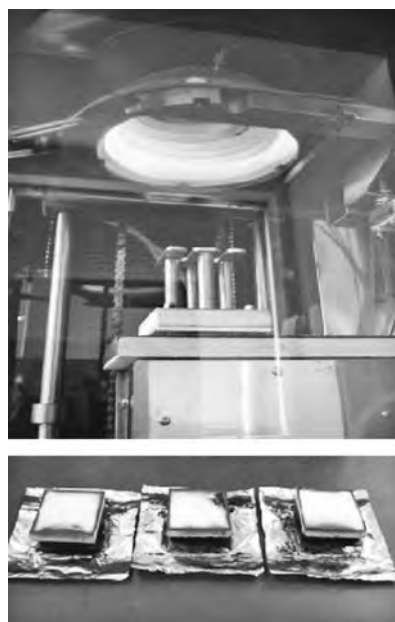
写真一4 発熱性試験 (上) と試験後のサンプル (下)
