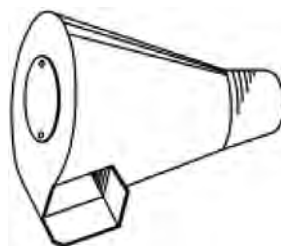
図一〇 代表的なボルテックスバルブの形状（Cタイプ）
