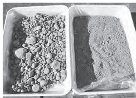
写真—3 粉碎・分級処理後の土砂
