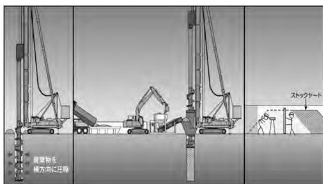
図二 海面処分場での施工手順
