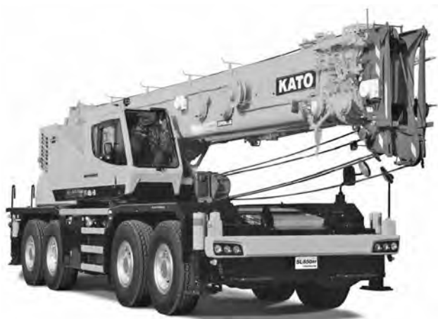
写真一六 加藤製作所 SL-850Rf PREMIUM ラフテレーンクレーン(伸縮ブーム型)
