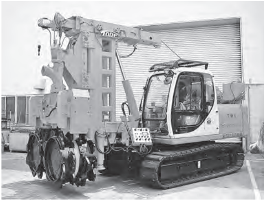
写真一3 MPD型ベースマシン搭載 水平多軸掘削機
