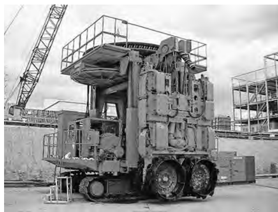
写真-2 MRD型低空頭檜台車搭載 水平多軸掘削機
