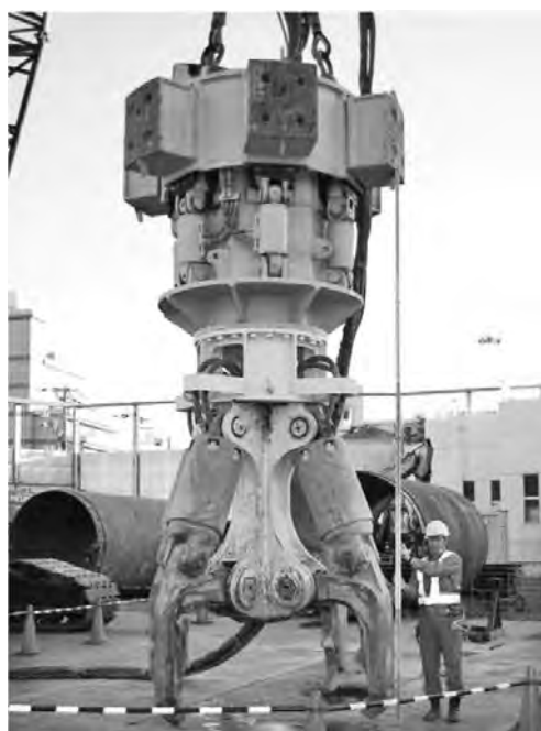
写真一10 本工法施工機 φ 3,000 mm 級 吊り下げ状況
