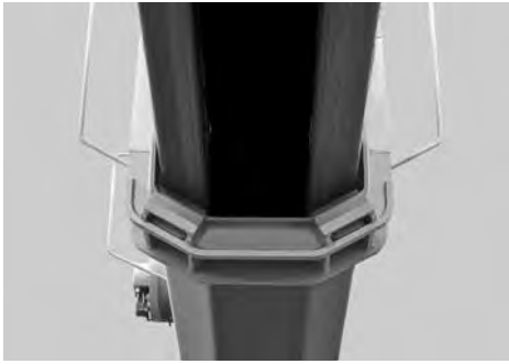
写真一 箱型伸縮ブーム
