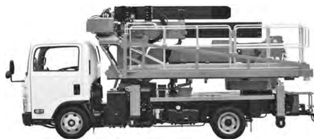
写真一七 アイチコーポレーション SF77B1FR 橋梁点検作業車（格納姿勢）
