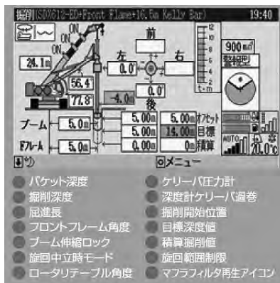
写真一六 大型モニタでの集中表示
