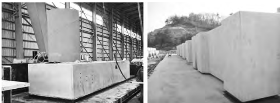
写真-1 コンクリートブロック (左: 底版 右: 防波版)
