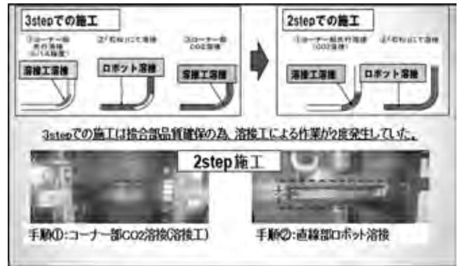
図一 4 鋼管コラム溶接手順の効率化
