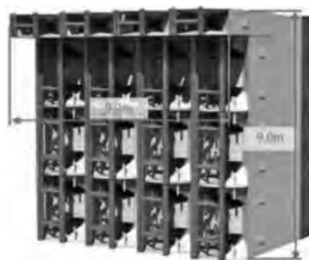
図一 2 最大拡幅機 (4 × 4)
