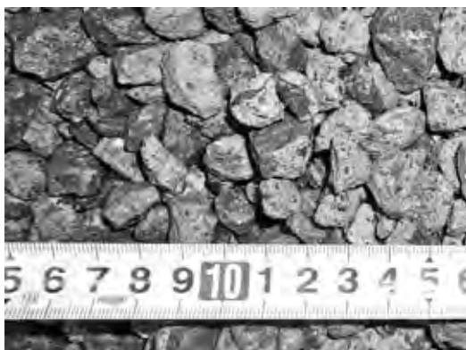
写真一1 再生粗骨材 AM
