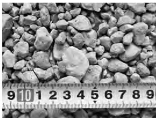
写真一4 再生粗骨材 CH
