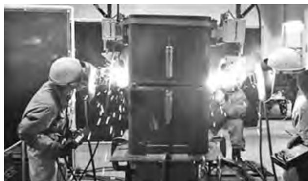
写真-8 現場ロボット溶接事前検証試験
