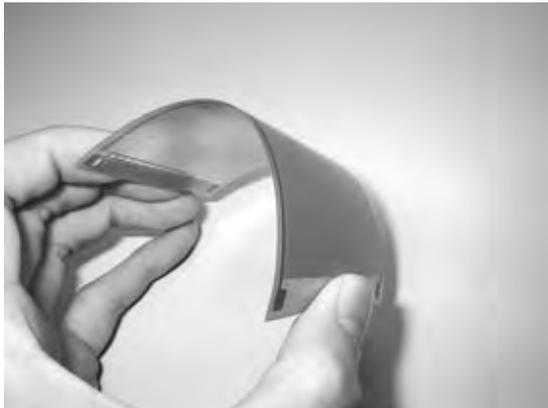
写真一 膜型圧電セラミックス
