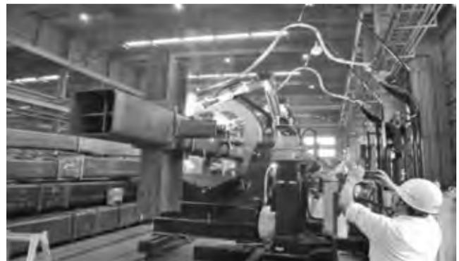
写真—1 鉄骨製作工場溶接ロボット
