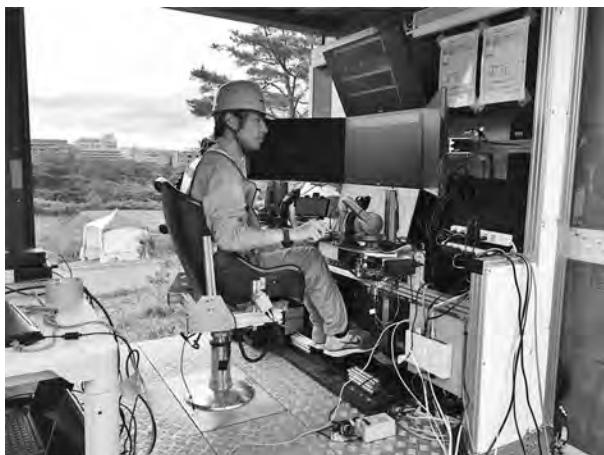
写真—3 遠隔操作コクピット
