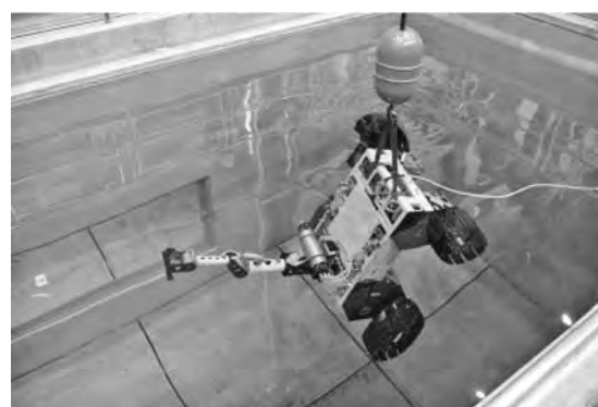
写真—5 緊急回収時の吊り上げ確認
