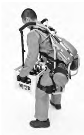
写真一五 腕支援機能付きパワーアシストスーツ ATOUN MODEL As
