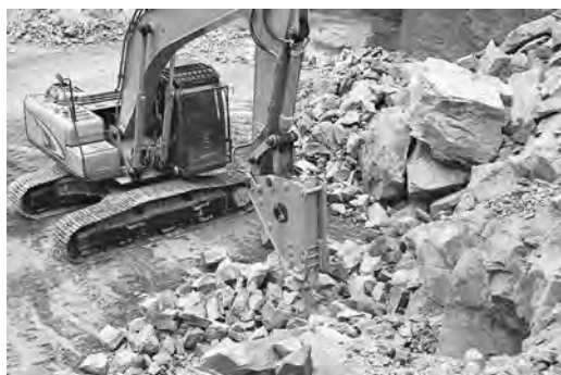
写真—1 油圧ショベル+ブレーカの稼動写真
