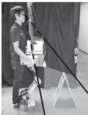
写真—7 操作者の死角の範囲 (左) とモニタリングシステムによる視界の確保 (右)
