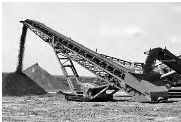
写真—6 ST80T 自走式ベルトコンベヤ
