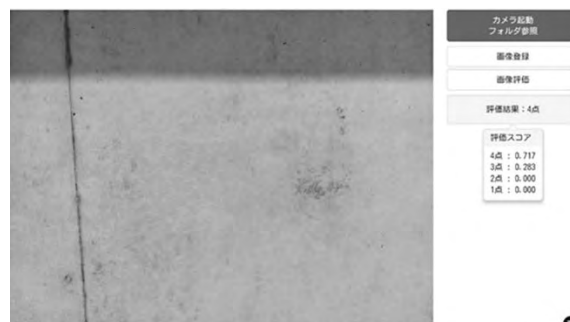
図—7 AIによる画像診断結果
