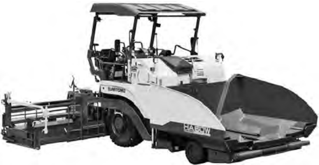
写真—9 住友建機 HA60W-10 アスファルトフィニッシャー
