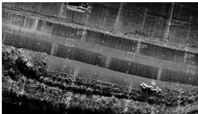
図—6 手押車型 MMS の計測データと検証箇所
