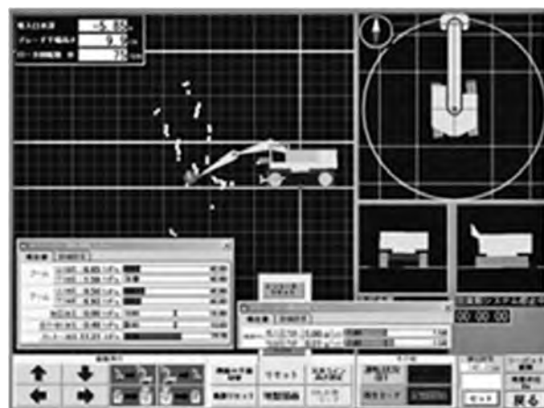
図—2 施工管理装置画面
