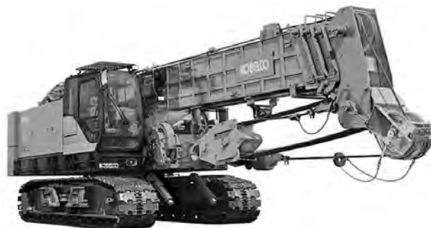
写真-7 伸縮ブーム
