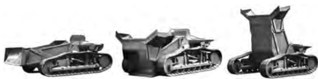
写真—25 転倒ボウル型の試作SR39
