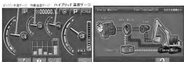
図—10 ハイブリッド温度ゲージ、エネルギーモニター
