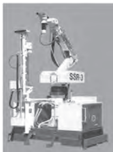
'82 耐火被覆吹付ロボット
