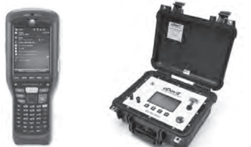
写真—6 電子雷管と発破制御システム
