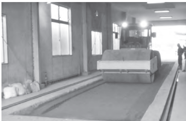
写真-1 実大締固め試験状況
