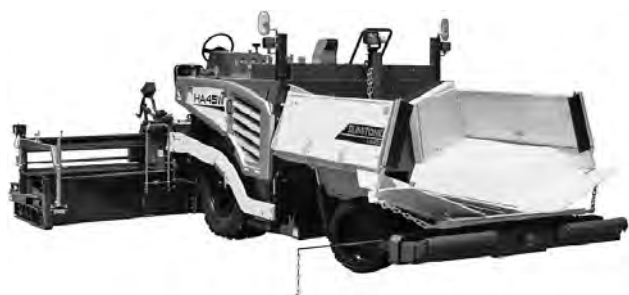
写真—6 住友建機 HA45W-10 アスファルトフィニッシャー
