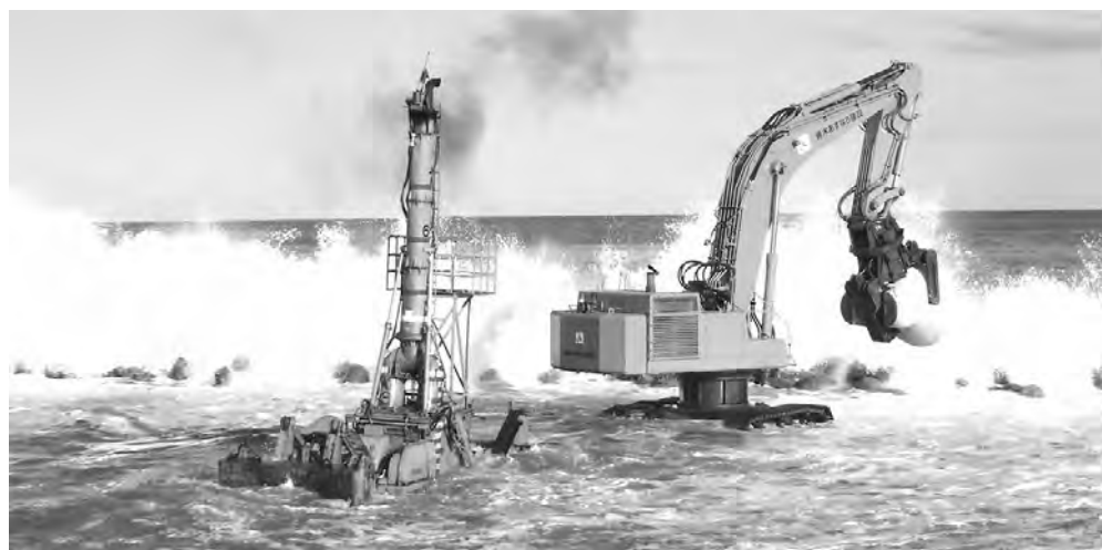
写真—1 遠隔操縦式水陸両用大型バックホウ、水陸両用ブルドーザ
