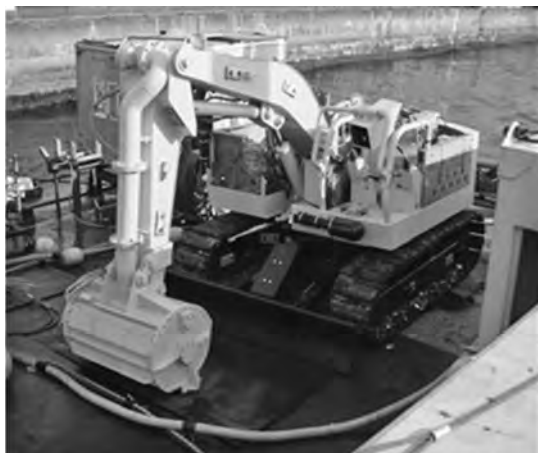
写真—1 本遠隔操縦 BH
