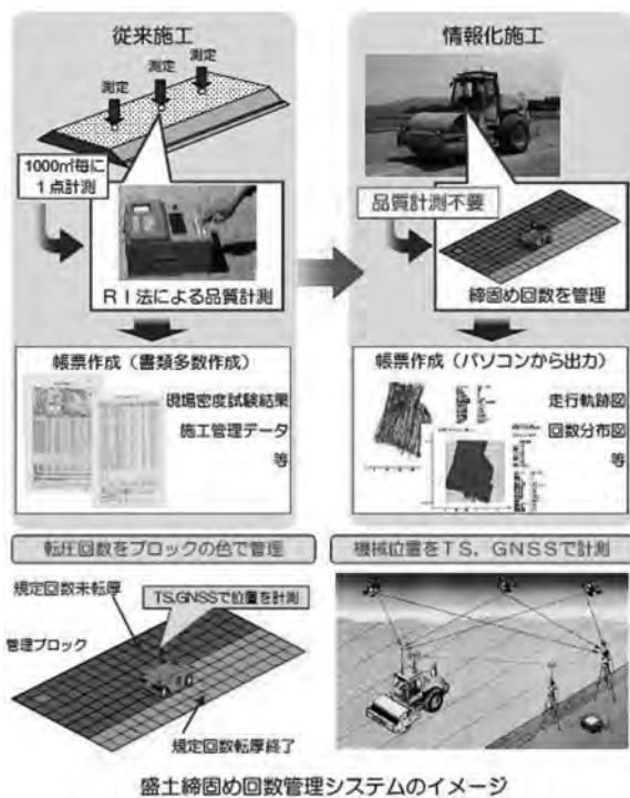
図—2 従来施工と情報化施工の比較
