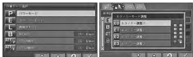
図一 13 作業モード選択画面，Eモード調整画面
