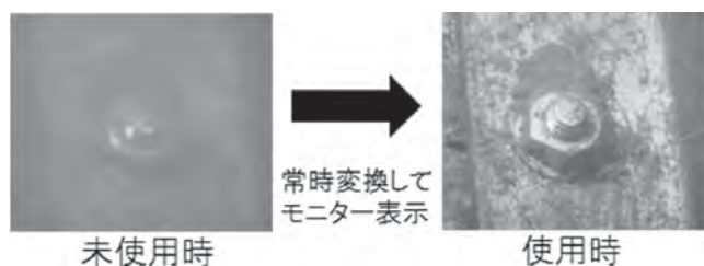
写真—1 画像詳細強化装置による効果
