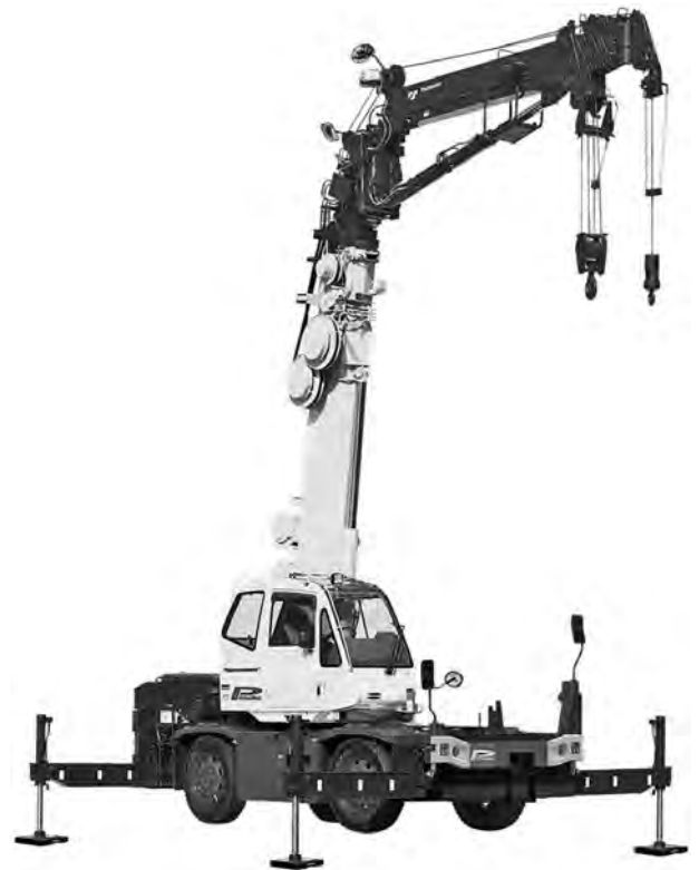
写真一 4 タダノ GR-130F ラフテレーンクレーン (作業姿勢)
