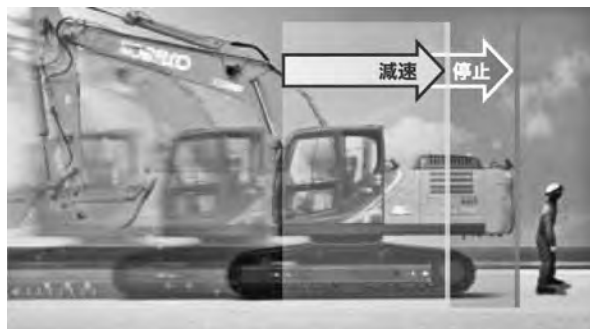
図—7 走行時の自動減速／停止
