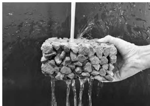
写真－1 ポーラスコンクリート
