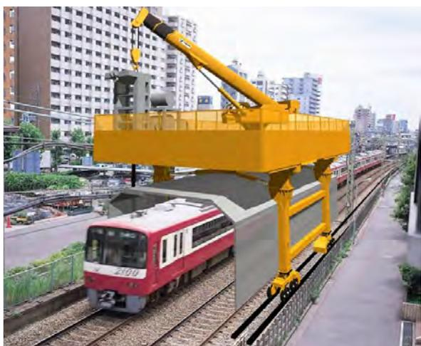
図-2 移動式直接高架施工機施工イメージ図
