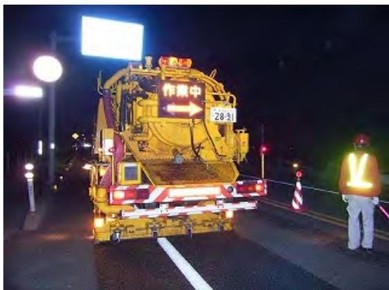
写真-1 排水性舗装清掃作業
