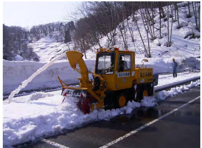
写真-2 雪詰まり防止機構の試験状況
