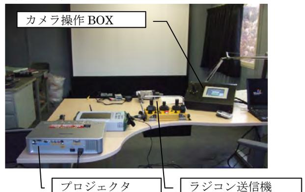
写真5 遠隔操縦装置
