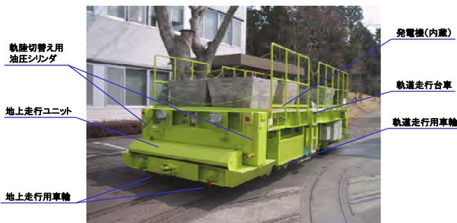
図-4 軌陸式重量物運搬台車
