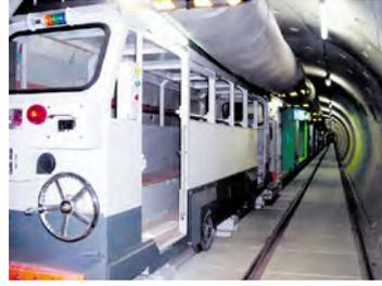
写真-8 セグメント搬送状況 写真-9 自走式緊急避難人車
