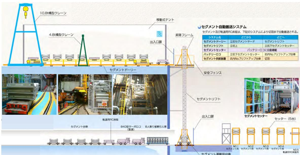
図-4 立坑搬送設備概要図
