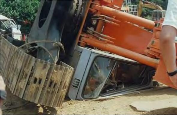
写真4 実機横転試験状況 (旧 EX-3型)
