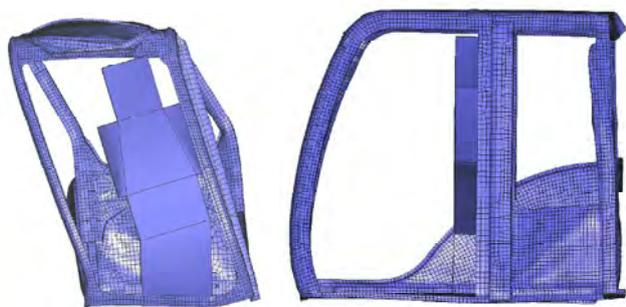
図9 ROPS 負荷時変形状態
