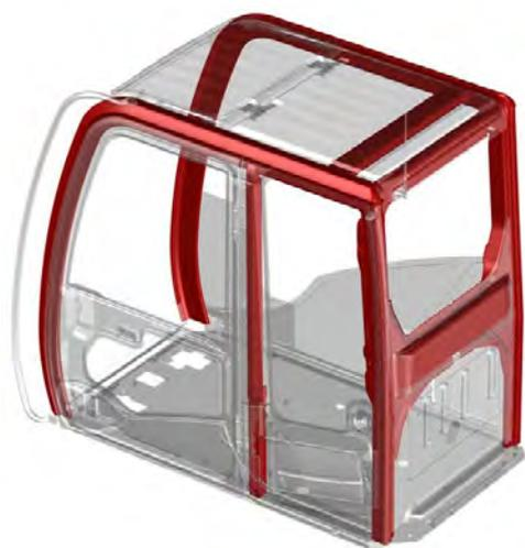
図8 Bタイプキャブ構造
