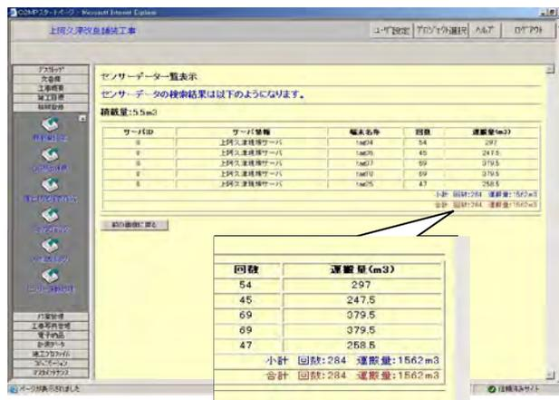
図3 ダンプ毎の運搬量表示画面
