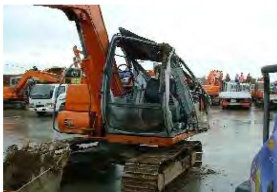
写真2 実機転倒事故状況 (旧 EX-5 型)
