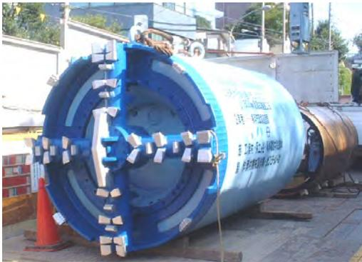
写真-3. 泥濃式回収型掘進機
