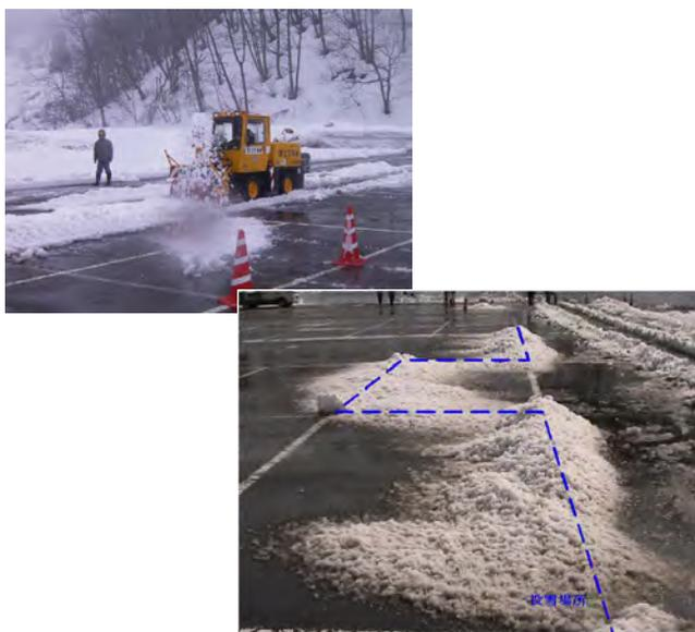
写真-6 集約型操作レバーの試験状況
