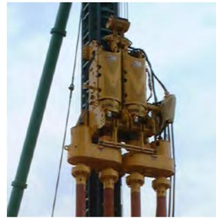
写真-2 4軸処理機（上部）
