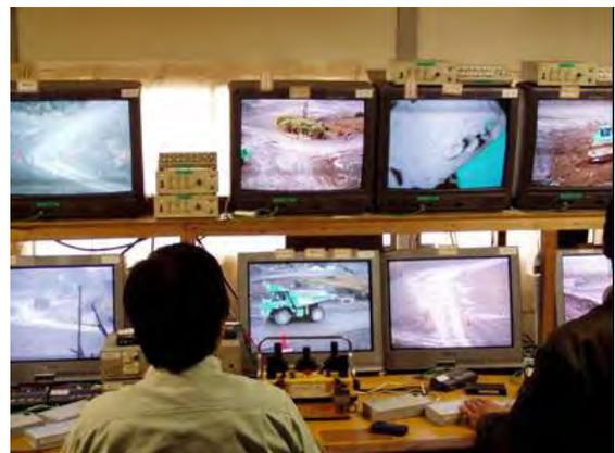
写真1 映像を使用した遠隔操作室
