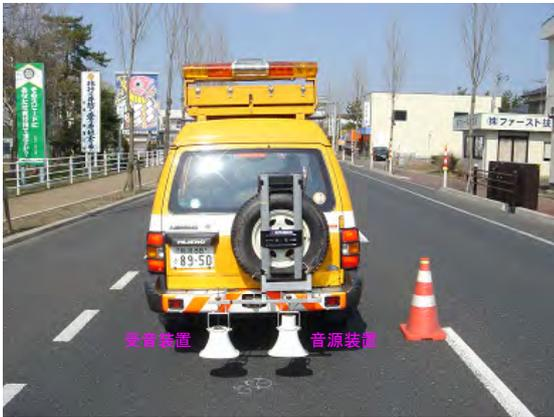
写真-3 音源・受音装置
