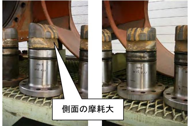
写真-2 リレービット側面摩耗状況
