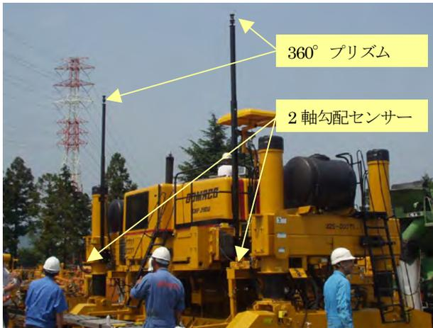
写真-2 センサー取付状況
