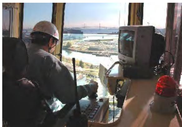
写真2 タワークレーン・オペレータ室の回転灯
