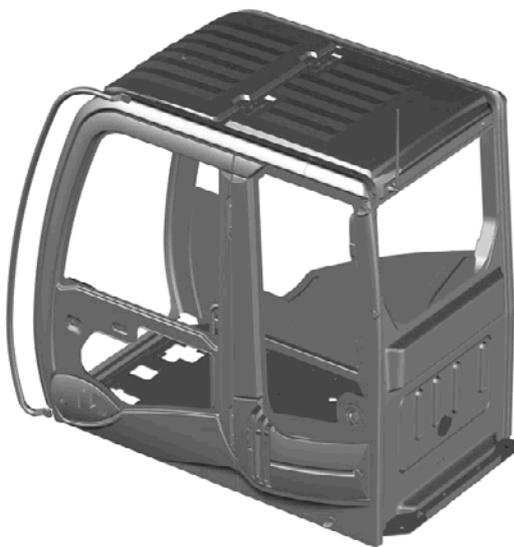
図6 ZX-3 ROPS キャブ構造
