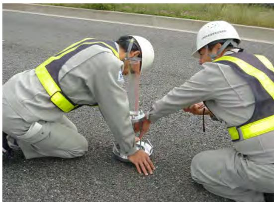
写真-2 現場透水量の測定
