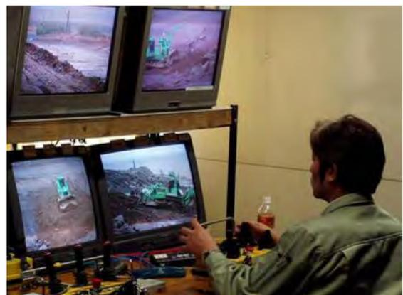
写真2 映像を使用した遠隔操作室
