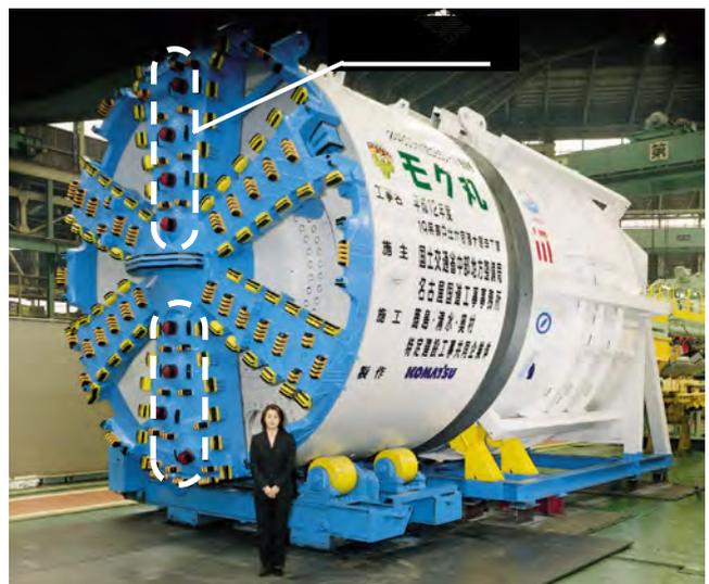
写真-1 φ4,800mm 春日井共同溝シールド機
