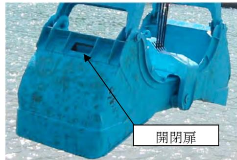
写真-4 水抜き機構
