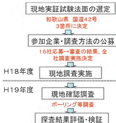
図3 物理探査技術評価・検証フロー
