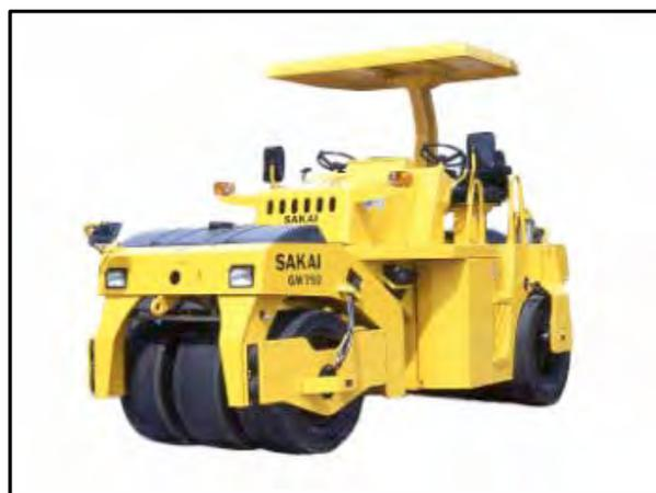
写真 1 振動タイヤローラ GW750 型
