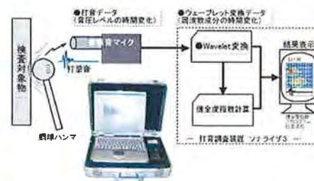
図6 打音調査原理(ウェーブレット法)
