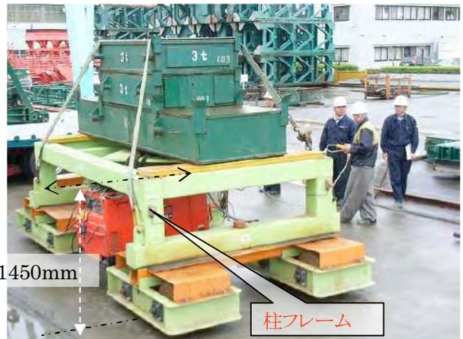
写真-6 走行フレーム荷重(16t)走行テスト
