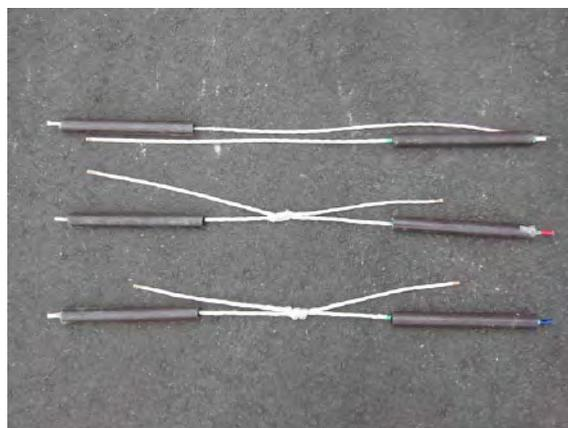
図9 接続部の引張試験用供試体
