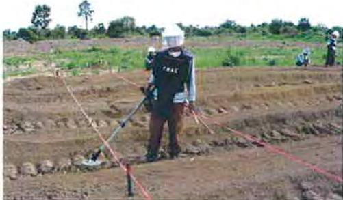
写真 21 除去跡地での探知作業
