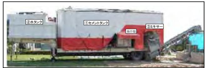
写真-1 湿潤セメント製造装置外観
