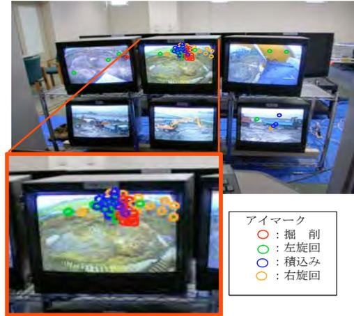
写真-4 オペレータの注視点(モニタ6台)
