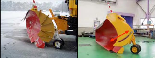
写真6 最適なデフレクタ形状(左)と試作機(右)
