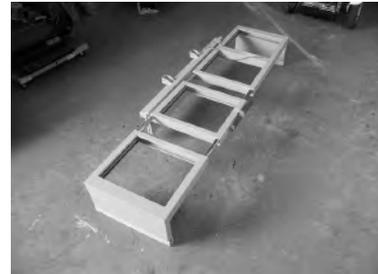
写真-5 アンテナ伸縮装置
