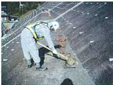
写真5 表面波探査状況
