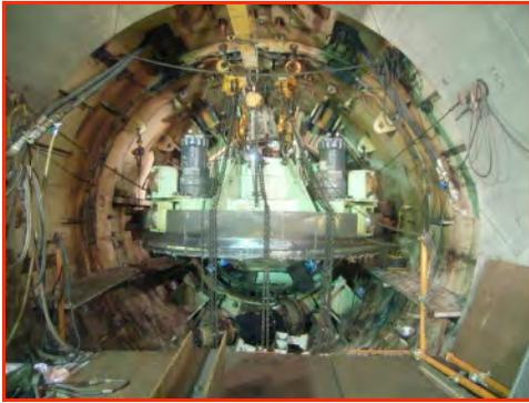
写真－9 駆動部引抜き・反転完了
