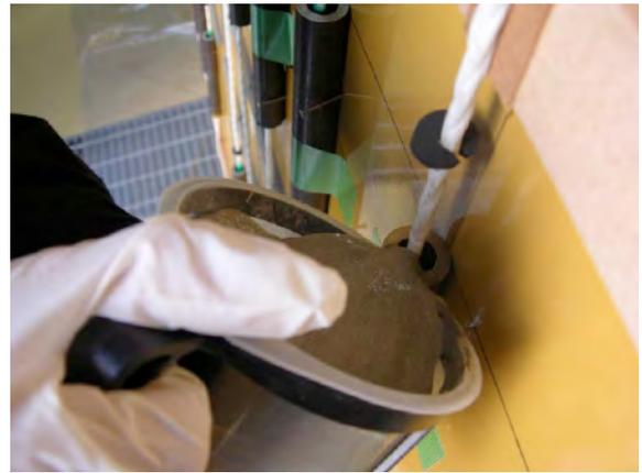
図6 定着用膨張材の充填状況
