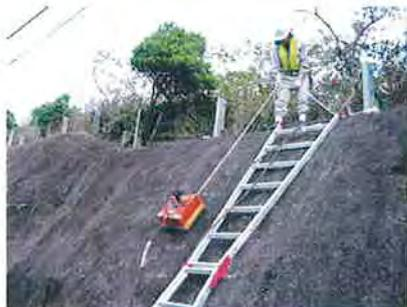
写真6 地中レーダ探査状況
