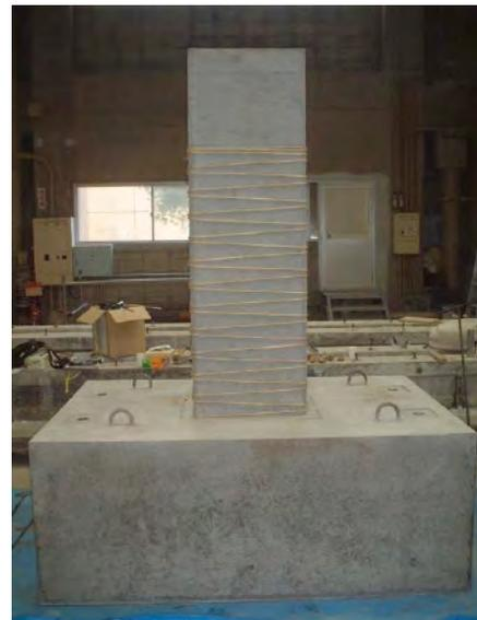
図2 耐震補強(既設構造物)
