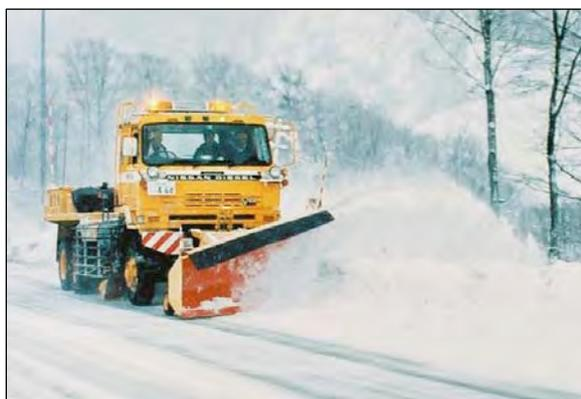
写真1 除雪トラック作業状況
