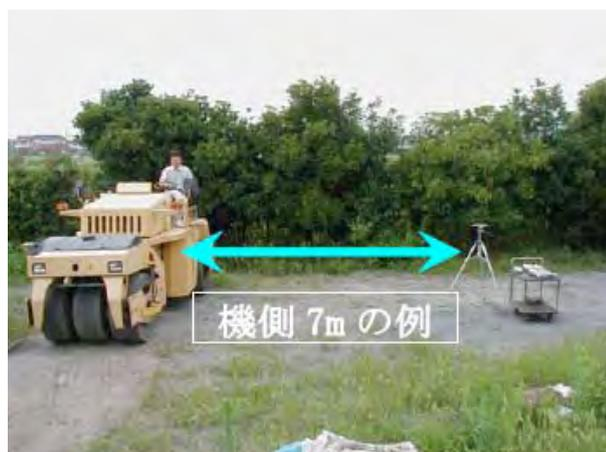
写真2 路盤上での騒音・振動測定の場合
