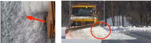
(測定データ)投雪距離:283cm、飛雪距離:118cm
