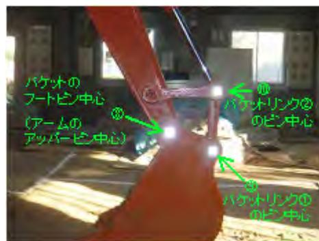
図-5 精度確認試験プリズムシート貼付け例
