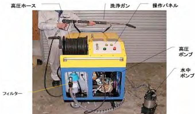
写真-2 簡易橋梁洗浄装置前面
