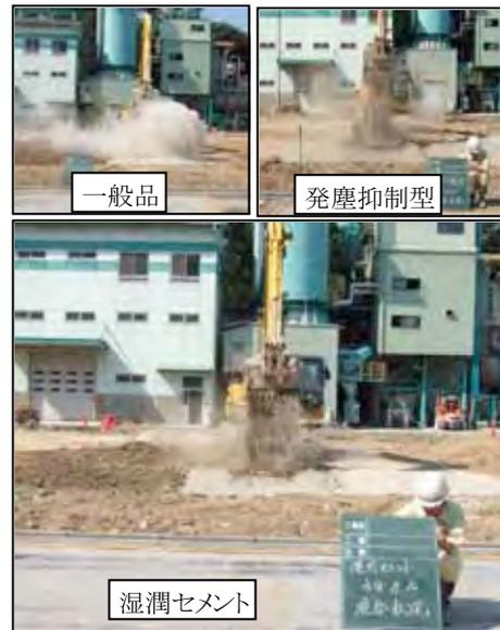
写真-2 発塵抑制効果の確認状況
