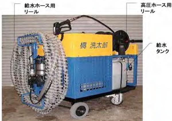
写真-3 簡易橋梁洗浄装置側面
