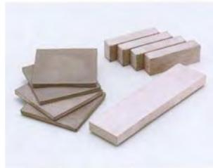
写真 1 TiB<sub>2</sub> 保護板
