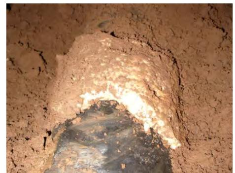
写真-6 鋼管周辺のシリカレジンの付着状況（従来工法）
