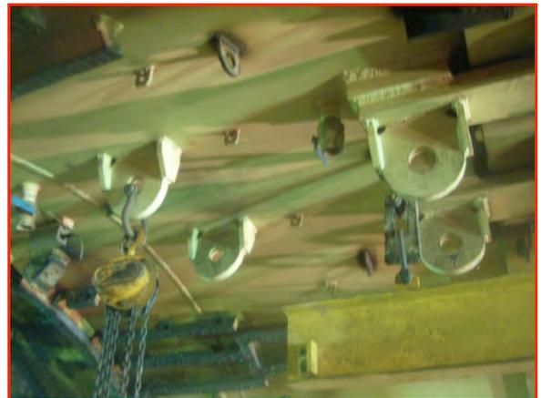
写真-7 反転用吊金具 (マシン上部)
