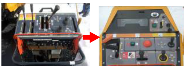
写真3 操作レバーの簡易化
