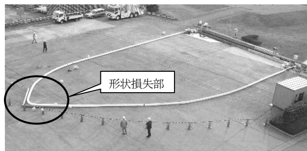
写真-2 形状部をホース中間位置に配置した状況 各形状損失の布設状況を写真-3～5 に示す。
