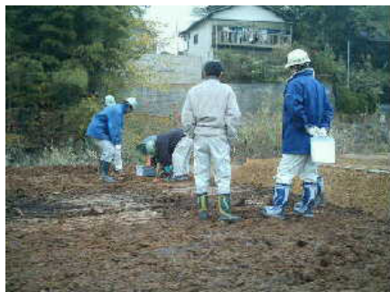
写真5 密度試験・コーン指数確認
