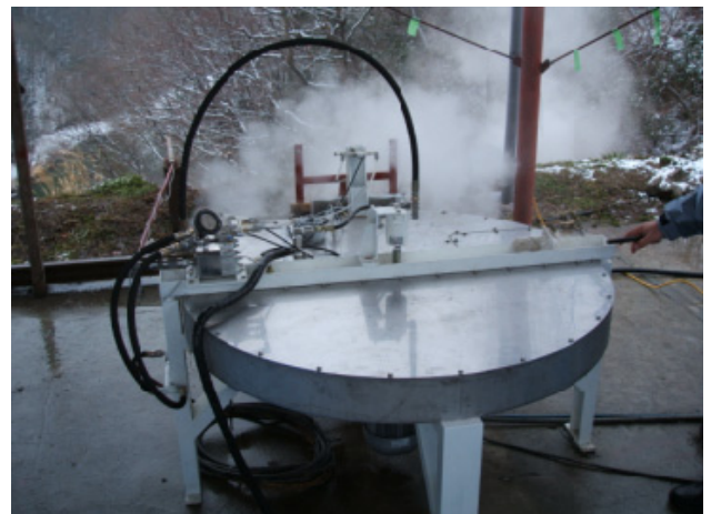
図-8 回転繰返し噴射試験機
