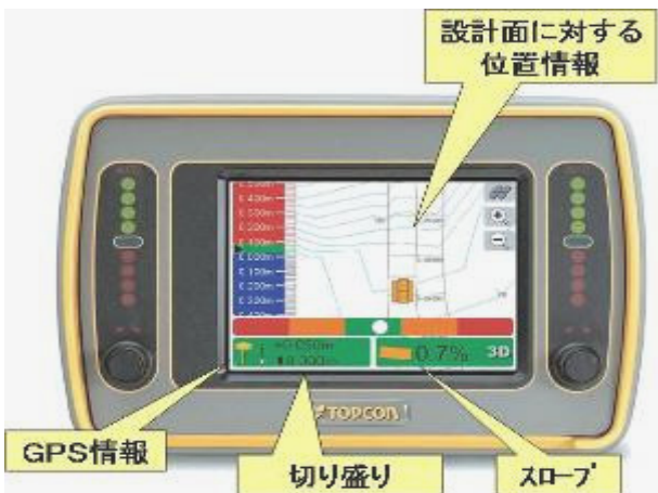
写真-2 ブルドーザー用コントロールボックス
