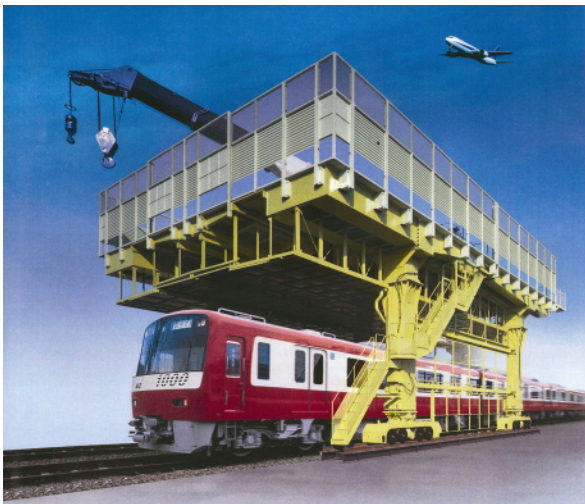
図-2 直接高架施工機による施工イメージ図
