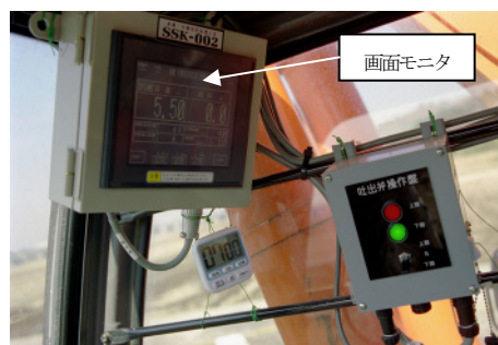
写真-3 オペレータ席内管理モニター
