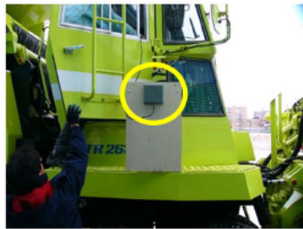
写真-10 RFIDアンテナ
