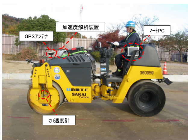
写真 - 1 4 t コンバインドローラ
