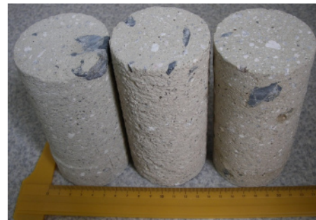
写真-2 供試体(破碎片)
