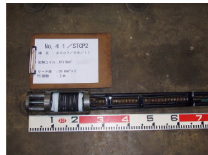
写真-7 鋼製第1耐荷体
