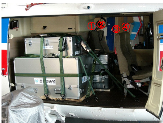
写真-6 ユニットの固縛状況
