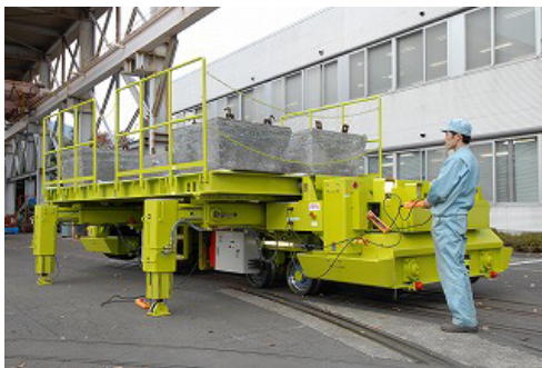
写真－3 軌陸式重量物運搬台車
