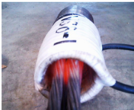
写真-1 PC鋼線加熱状況
