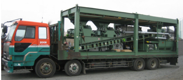
写真-5 トラック1台での運搬が可能
