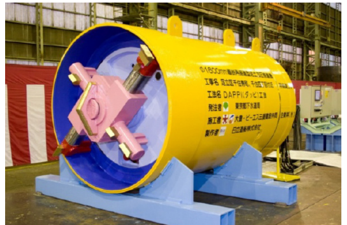
写真-1 φ1600mm DAPPI 掘進機
