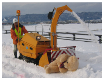
写真5 オーガ安全カバー機能確認
