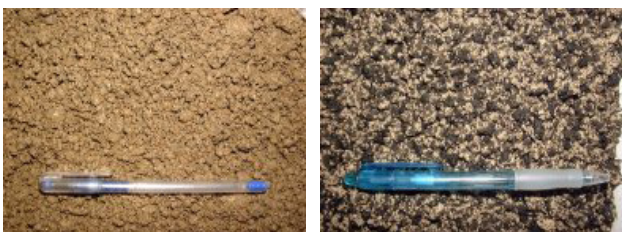
写真-7 アスミック表面状態
