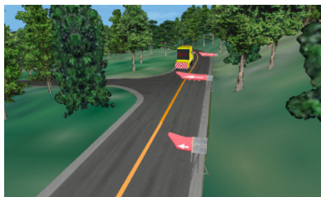
(d) 可搬型遮断機による交通規制（斜面崩壊部）
