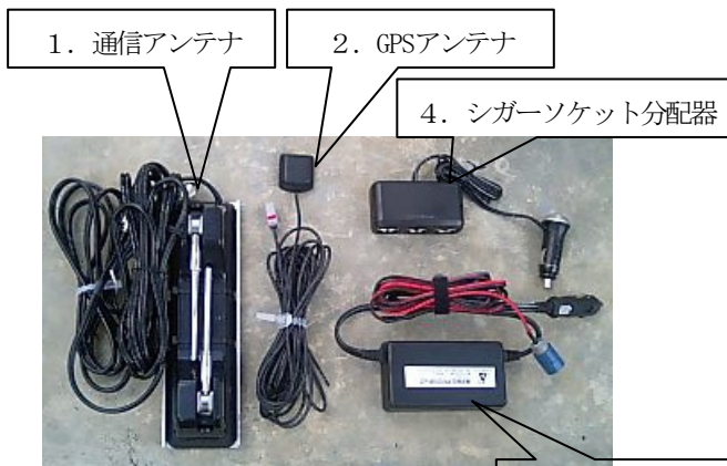
写真-2 外部配線機器
