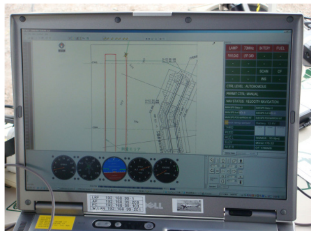
図-7 自立航行時の操縦画面
