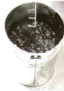
写真-1 フォームドアスファルト
