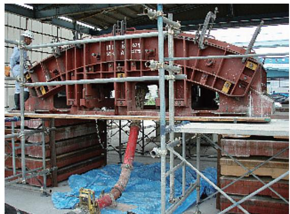
写真-2 打設試験用型枠
