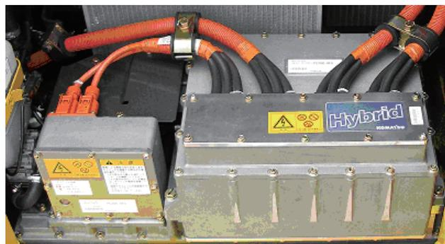
図-6 インバータ&キャパシタ搭載図
