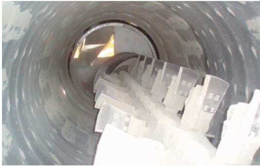
写真-2 新型混合装置内部
