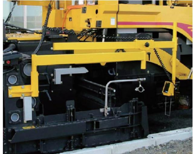
写真-2 超音波式取り付け状況
