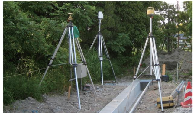
写真-1 GNSS 式基地局設置状況
