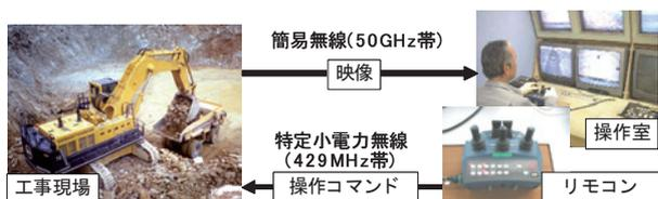
図-1 無人化施工遠隔操作システム
