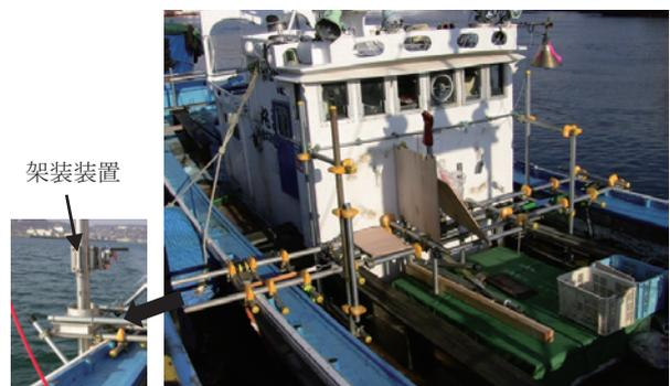
写真-9 単管パイプによる艀装用架台
