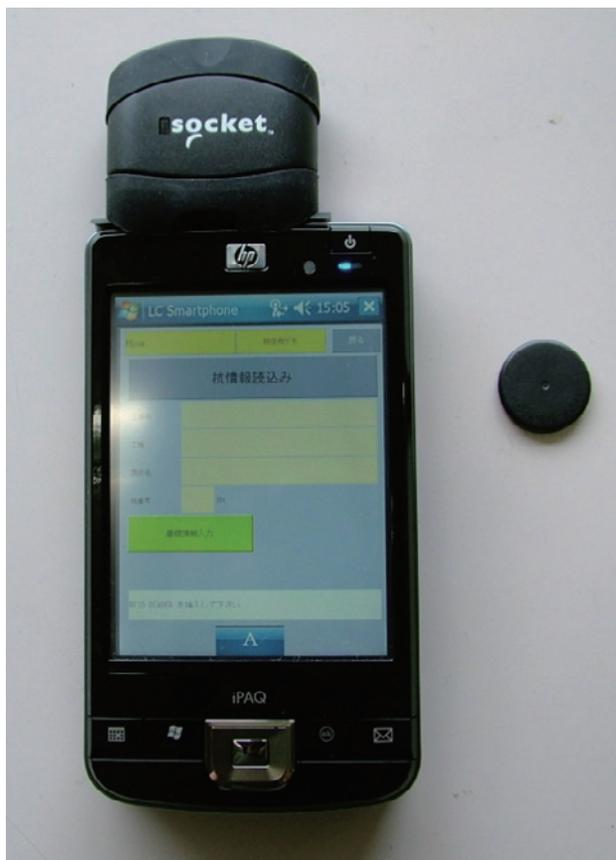
図-6 PDA, RFIDリーダ, RFIDタグ
