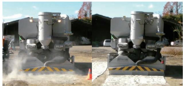
写真-7 回収なし (左) と回収あり (右) の発塵状況の違い
