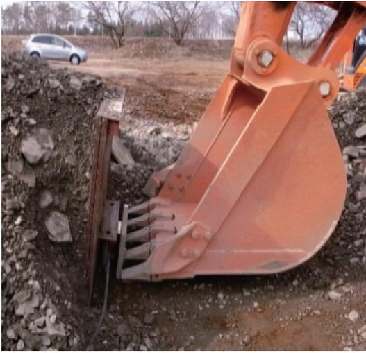
写真-3 水平荷重実験状況
