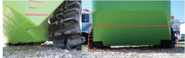
写真-12 前側フロート接触部
