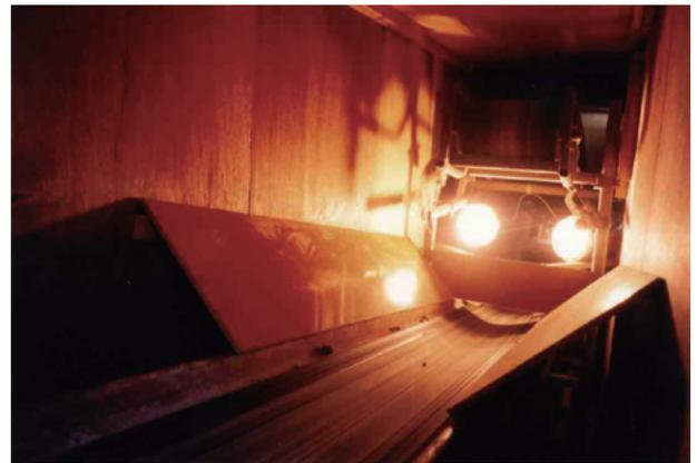
写真-5 ベルトコンベヤによる実験装置（箱の内部）
