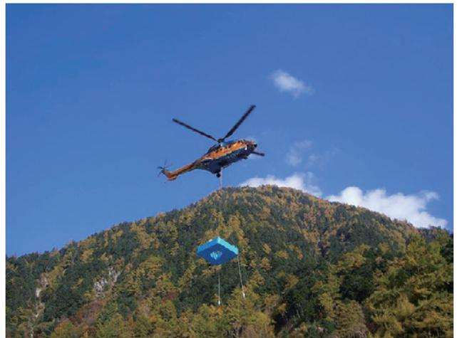
写真-6 ヘリコプターによる機材運搬状況
