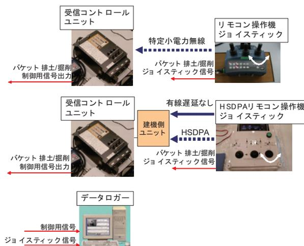
図-10 通信遅延計測実験システム構成図
