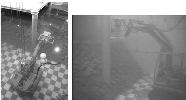
図-14 水槽内での肉厚計測実験
