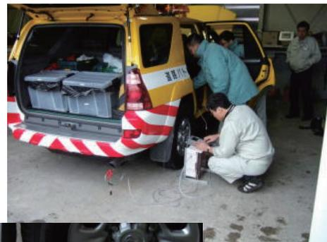
写真-5 「Auto5.1」(自動車排ガス分析計)による測定状況
