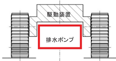
図-3 駆動装置及び排水ポンプ配置
