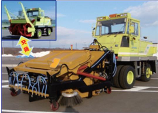
写真-1 ロータリ除雪車対応型路面清掃装置
