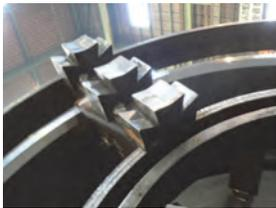
写真-5 ビット取付状況
