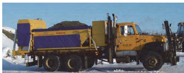
写真-2 カナダにおける加熱水混合散布に対応した機械の一例
