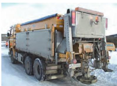
写真-1 ノルウェーにおける加熱水混合散布に対応した機械の一例
