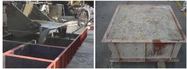
写真-3 供試体作製 (左: 流動化処理土打設、右: 硬化養生後)
