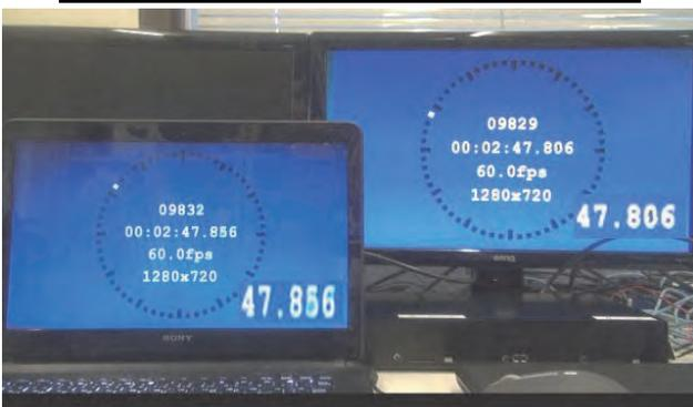
図-11 ビデオ変換機の遅延測定
