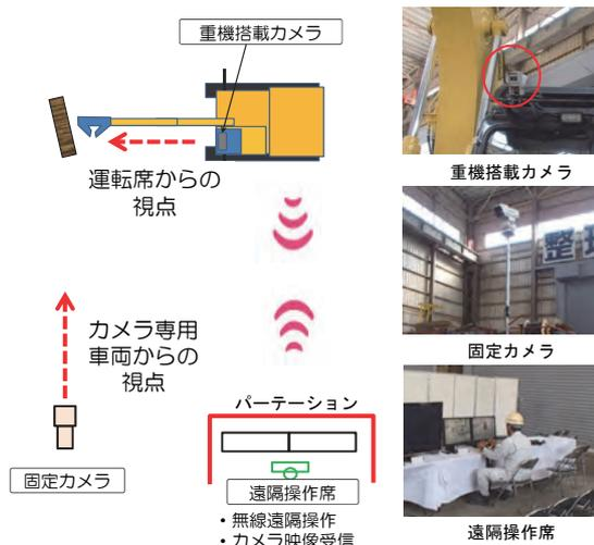
図-3 従来システムの実験配置
