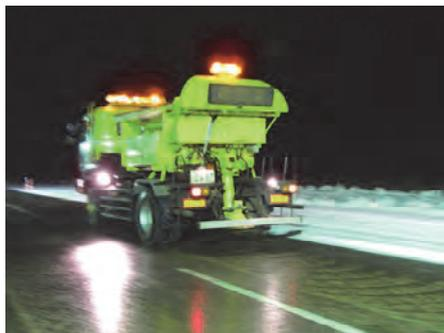
写真-4 凍結防止剤散布車による散布状況
