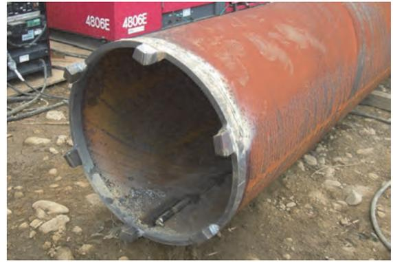
写真-6 砂礫地盤対応用ビット
