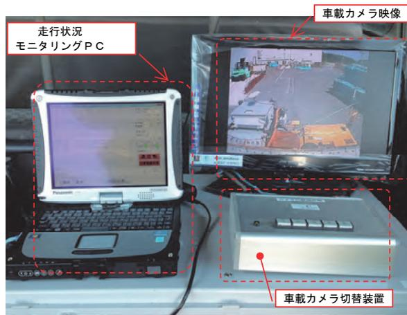
図-4 監視・指示システム（先導車内）
