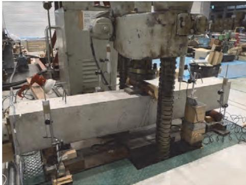
8体のRCはり供試体の曲げ載荷試験を行い、ひび割れの検知を試みた。
