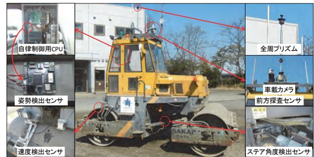
図-11 振動ローラと搭載センサ
