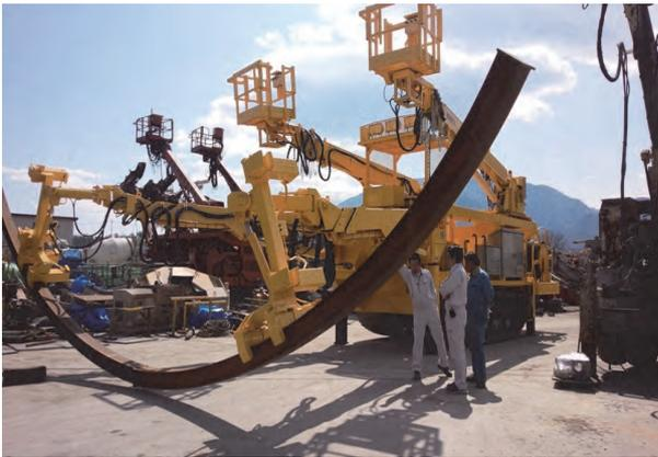
写真-3 インバートストラット地接合実験
