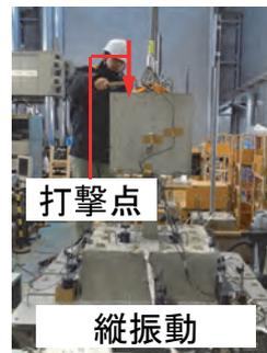
応答波形をフーリエ分析して固有振動数を算出
