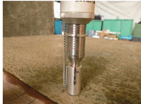
写真-4 針貫入試験による強度確認
