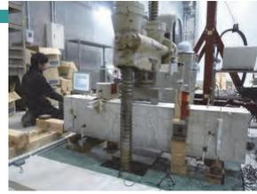
2. 柱供試体の振動台実験
