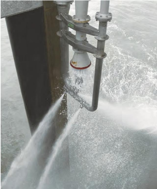
写真-1 ジェットポンプ気中試運転
