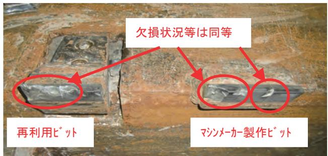
写真-5 掘進完了後のビット状況
