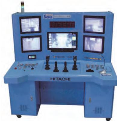
写真5. ASTACO SoRa 遠隔操作盤
