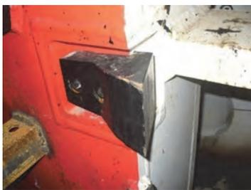
写真-3 再利用ビット取付状況
