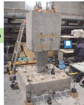
動的載荷により損傷を導入→全体の固有振動数を計測
