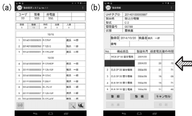
図-3 タブレットの画面の例。(a) 整備された製品を一覧表示している。(b) 分電盤の検査データを入力する画面。矢印の行は、この部品が品質基準を満たしていないことを強調表示している。
