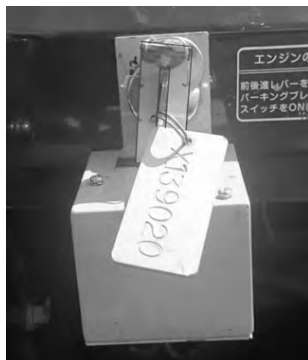
写真-2 キー回転装置の装着状況
