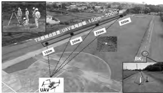
図-6 自動追尾TSの設置と実験風景
