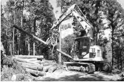
図-10 プロセッサによる造材状況
