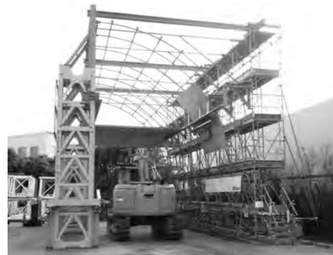
写真-4 天井板撤去実証実験設備
