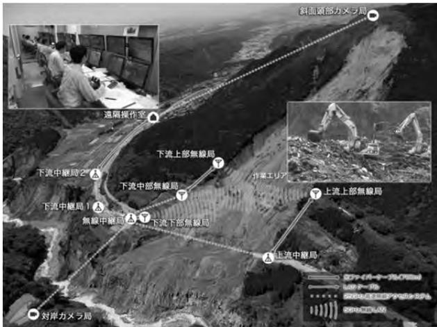
図-10阿蘇大橋地区斜面防災対策工事無線システム概要図
