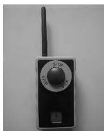
写真-5 緊急停止用ラジコン
