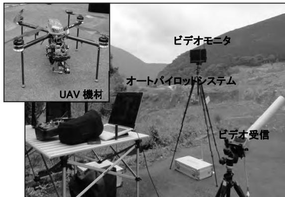
写真-1 使用機器(現地 UAV 計測機材配置状況)
