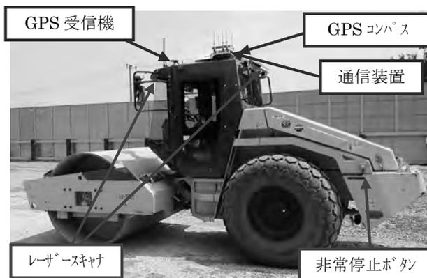
写真-1 自動化機器の配置 (振動ローラ外観)
