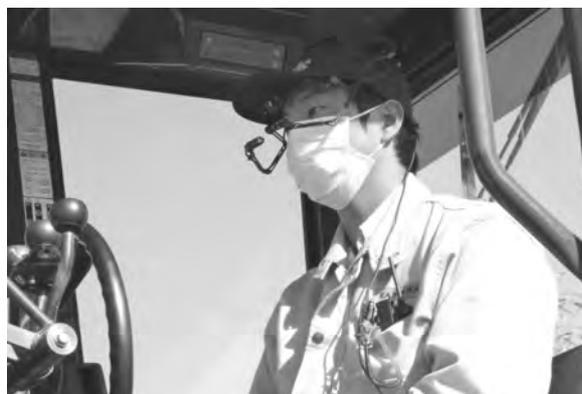
図-3 視線計測装置
