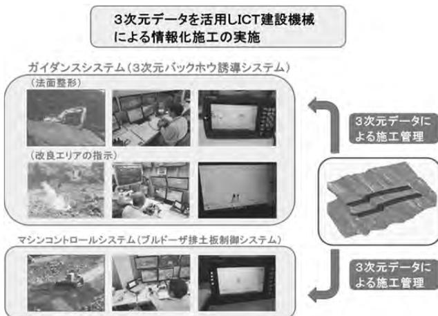
図-13 施工におけるi-Constructionの取組み
