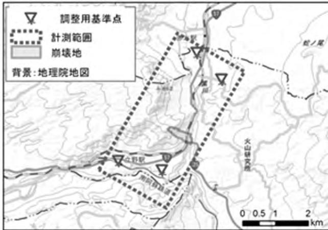
図-2 レーザ計測範囲及び崩壊位置図
