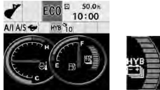
図-13 ハイブリッドシステムインジケータ
