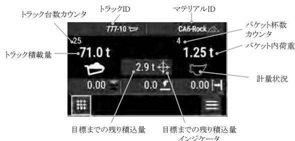
図-5 ペイロード計測システムのモニタ表示画面
