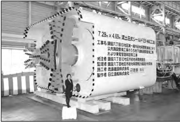
写真-1 横型2連矩形シールドマシン
