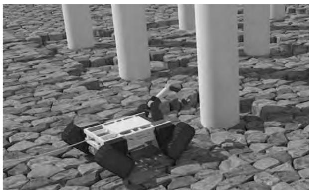
図-7 橋脚下部 洗掘調査 イメージ図
