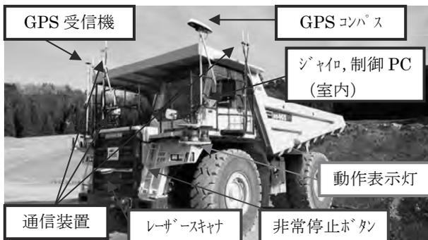
写真-6 自動化機器の配置(ダンプ外観)
