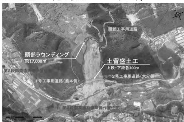
図-3 阿蘇大橋地区斜面防災対策工事全体概要図
