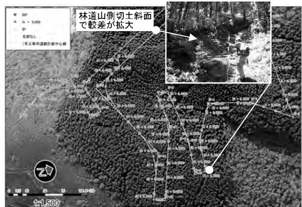
写真-2 頭部工事用道路中心線計画オルソ
