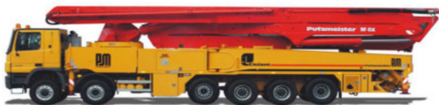
写真 3.3.1 ブーム長 63.5mのブーム付きコンクリートポンプ車（プツマイスター製）
