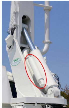
図-4.5.2 ブーム制振装置
