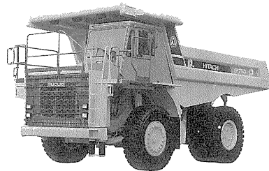
写真—5 日立建機 EH 750 重ダンプトラック
