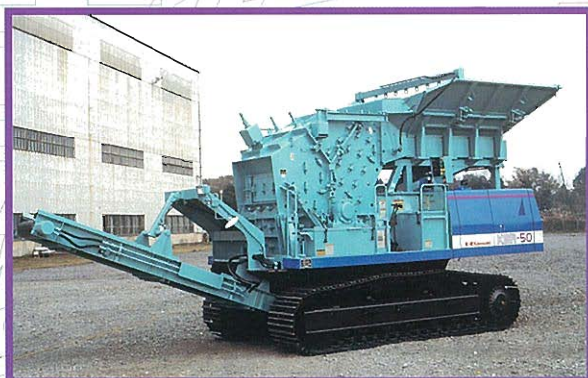
↑コンクリート塊移動式リサイクルプラント
