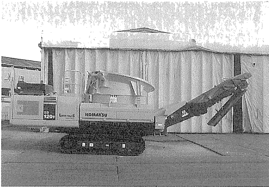
写真一 自走式木材破砕機外観 (BR 120 T)
