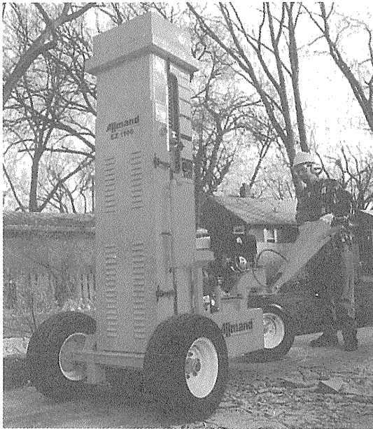
写真—2 Allmand Bros. 社の自走式コンクリートブレーカ EZ
