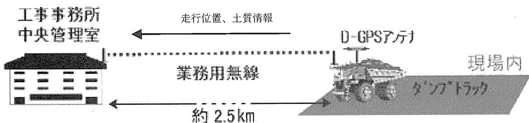
図-3 GPSを利用したダンプトラック運行管理システム
