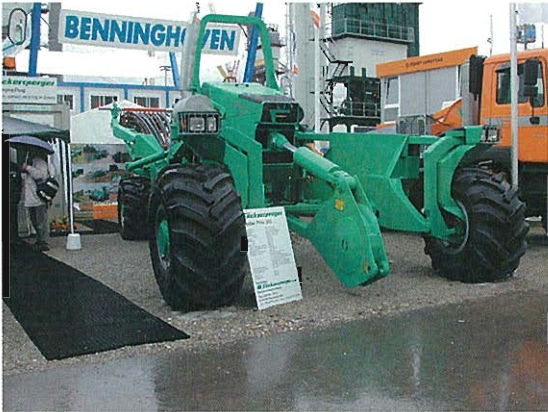
⇨ ケーブル埋設機
