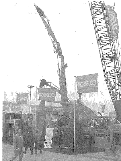
写真—9 超ロングビル解体専用機 Kobelco-SK 480 LC
