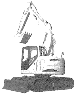
写真—3 住友建機「スピン・エース」SH 125 X-3 油圧ショベル（後方超小旋回型）
