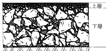
図-1 ワービット舗装の断面
