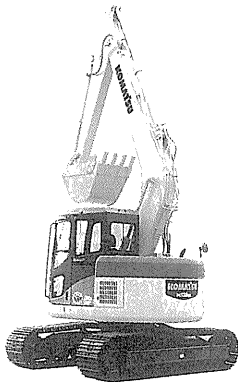
写真-1 コマツ「GALEO」PC 138 US -2 油圧ショベル (後方小旋回型)
