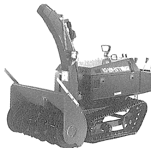
写真-7 ウェスタンコーポレーション「スノースロワー」10-18 HST 小型除雪機
