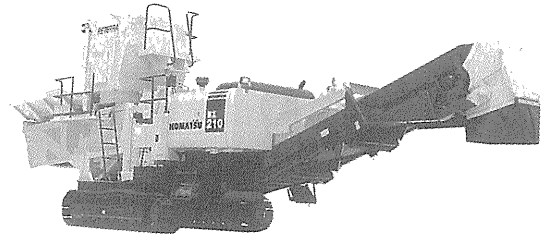
写真-5 コマツ「リテラ」BZ 210 1 土質改良機
