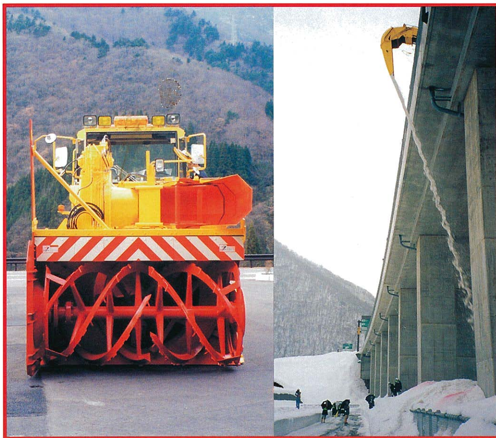
特殊シュート付きロータリ除雪車 2.6m級(300kW級), ツーステージ式, JR300(高速)型 TCM株式会社
