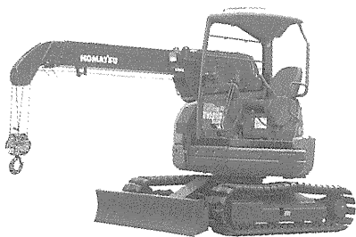
写真-6 コマツ LC383 3 クローラクレーン
