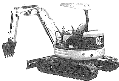
写真-3 CAT 304 CR 「REGA」小型油圧ショベル (後方超小旋回型)
