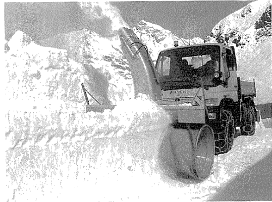
写真-10 スノーカッタと凍結防止剤散布機のコンビネーション
