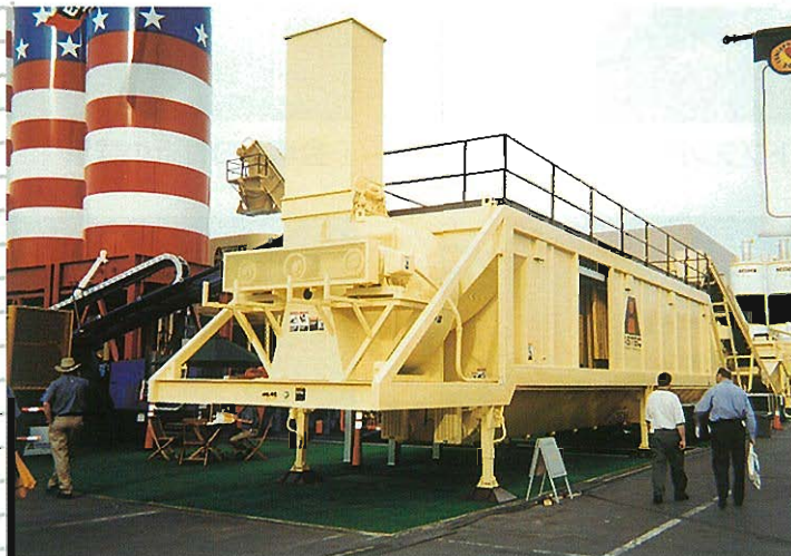
⇩ 可搬式コンクリートプラント
