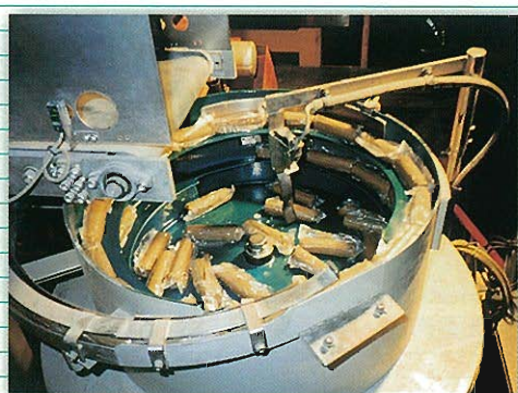
⇩ アンコ供給フィーダー
