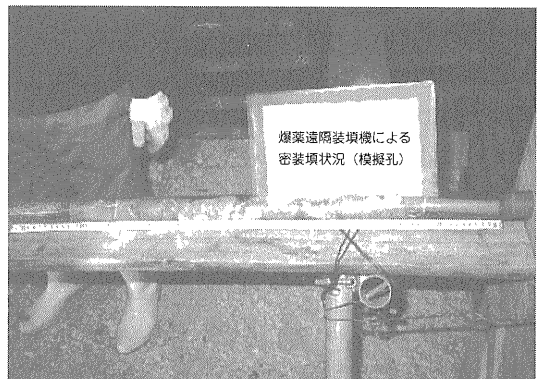
写真—7 模擬孔による本システムでの装填状況（親ダイを除いて増ダイ、アンコすべて個々に装填されている）
