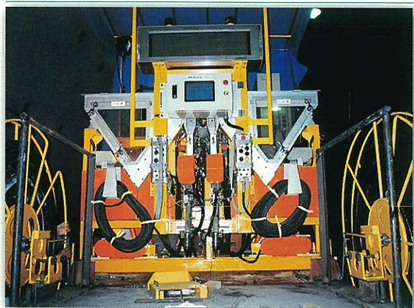
⇩ 爆薬遠隔装填装置 (台車に搭載)
