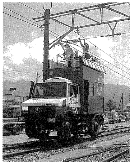
写真-6 ヤナセ U 400 ZA 多目的作業車 (狭軌用軌陸車)
