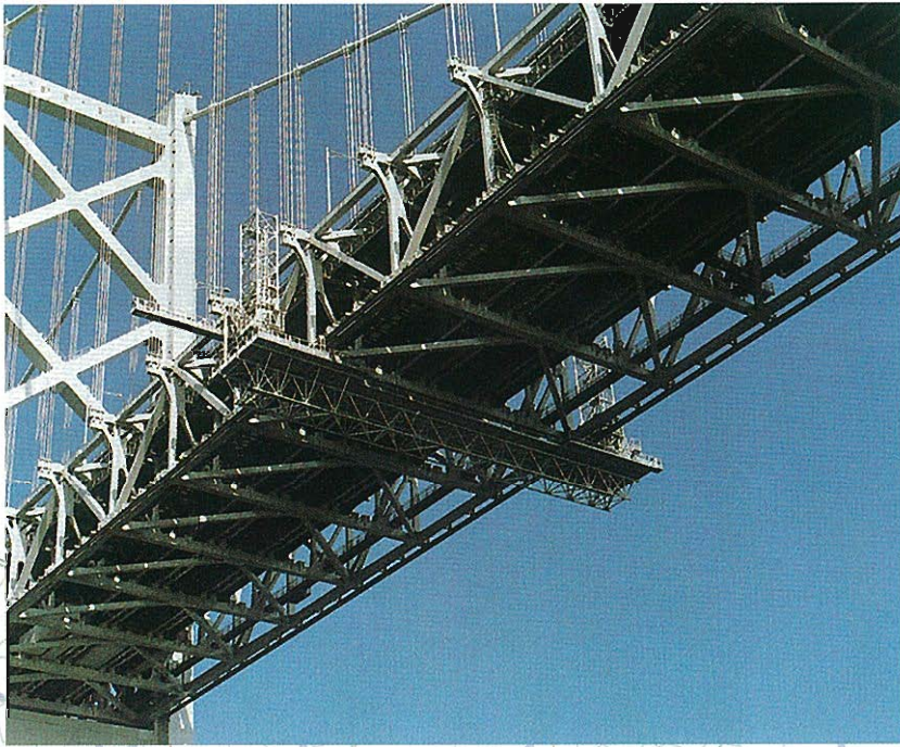
⇨吊橋・斜張橋用作業車 (北備讃瀬戸大橋)
