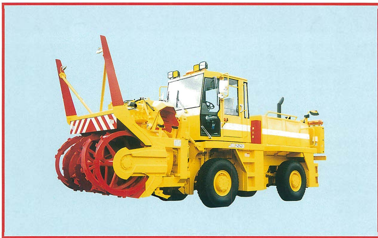
高速型ロータリ除雪車 JR 220(H)型 TCM 株式会社
