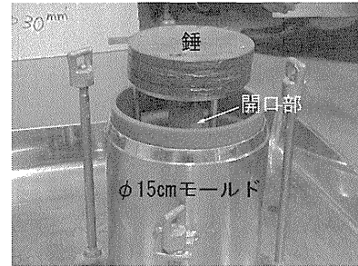
写真—5 押抜きせん断試験
