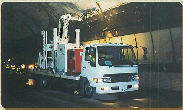
⇩ 打音診断機全景
